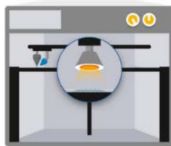
Aufschmelzen erfolgt über infiltrierte Bereiche mittels IR-Strahlung
