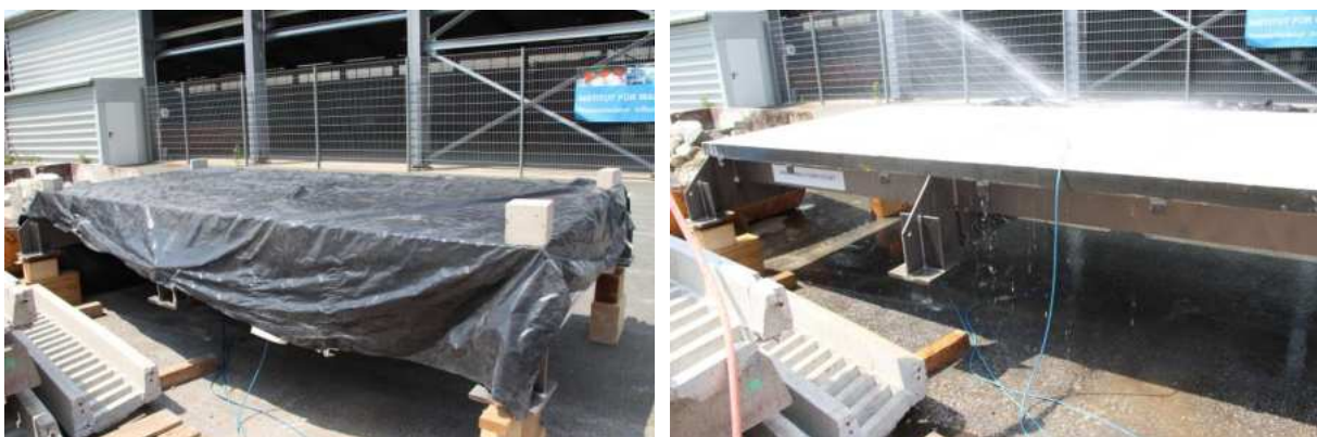
Abbildung E. 15: Bewitterung: links Aufheizen, rechts: Abschrecken durch Beregnung
