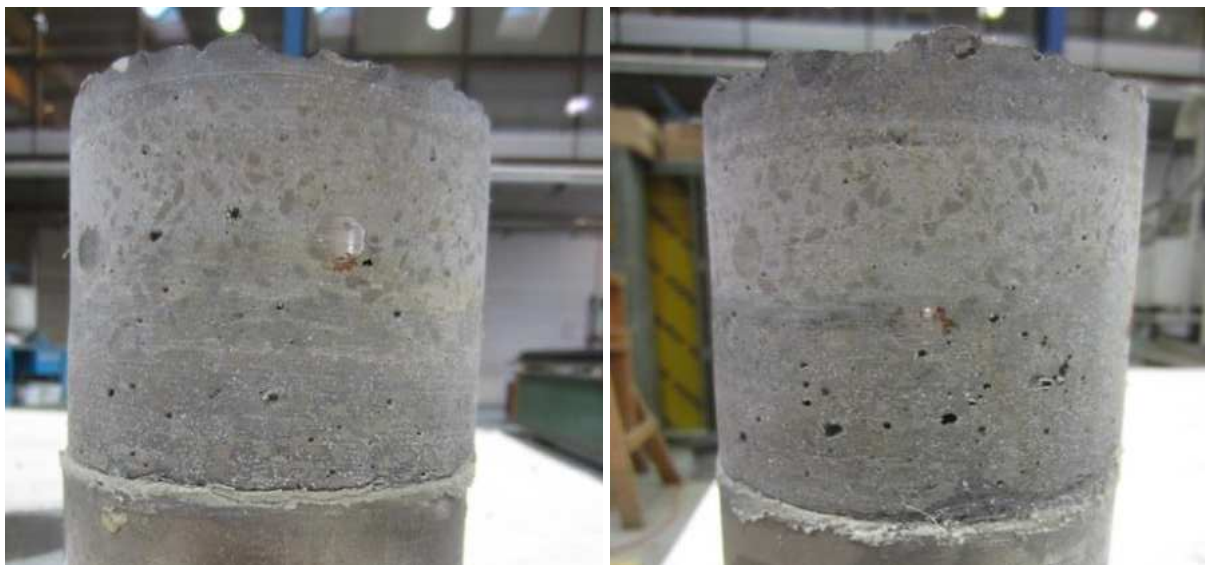
Abbildung E. 27: Bohrkern mit der Bruchfläche nach oben; Links: Prüfkörper A1-1; Rechts: Prüfkörper A3-3
