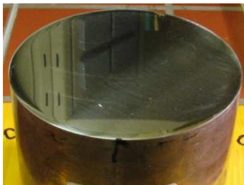
Abbildung 3.13: Glatt polierte Stahloberfläche [18]
