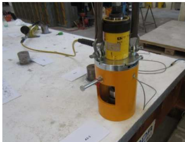
Abbildung E. 17: links: aufgeklebter Stempel, rechts: Haftzugprüfgerät mit Hohlkolbenzylinder
