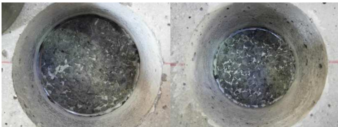
Abbildung D. 16: Bruchbild Indubond 2 (links) SikaDur 2 (rechts)
