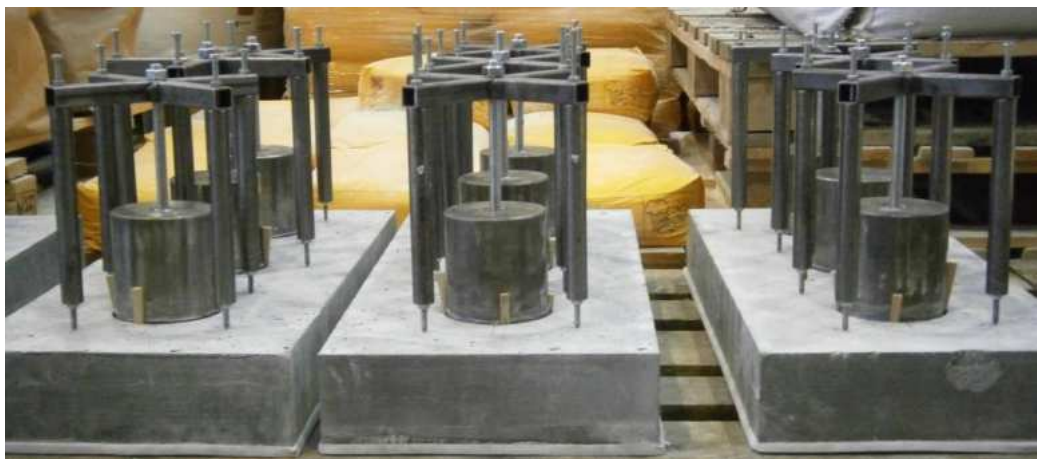
Abbildung D. 13: Aufkleben der Stahlzylinder für die Haftzugprüfung mit Abstandhalter
