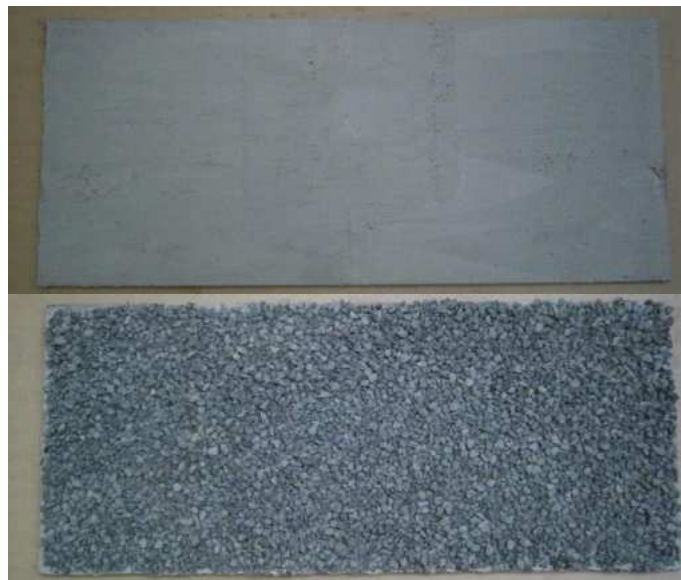
Abbildung D. 10: Stahlplatte mit Epoxidharzbeschichtung (oben) und mit Basaltspliteinstreuung (unten)
