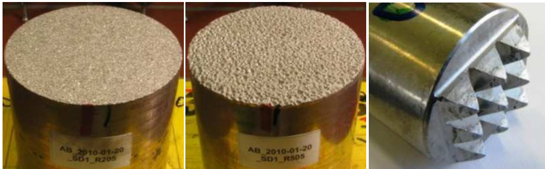
Abbildung 3.14: Stahlproben mit verschiedenen Rauheitsgraden (links und Mitte), Spitzhammer (rechts) [18]
