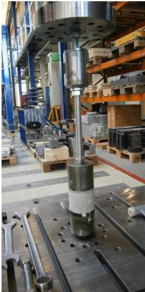
Abbildung D. 2: Universalprüfmaschine mit Verbundprobe (links), Skizze Versuchsaufbau (rechts)
