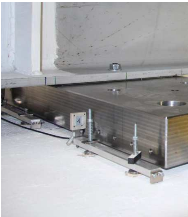
Abbildung E. 12: links: Setzdehnungsaufnehmer, rechts: Dehnmessstreifen
