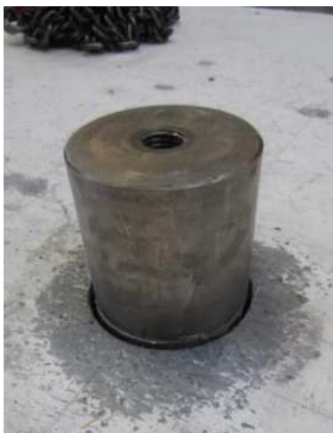
Abbildung E. 17: links: aufgeklebter Stempel, rechts: Haftzugprüfgerät mit Hohlkolbenzylinder
