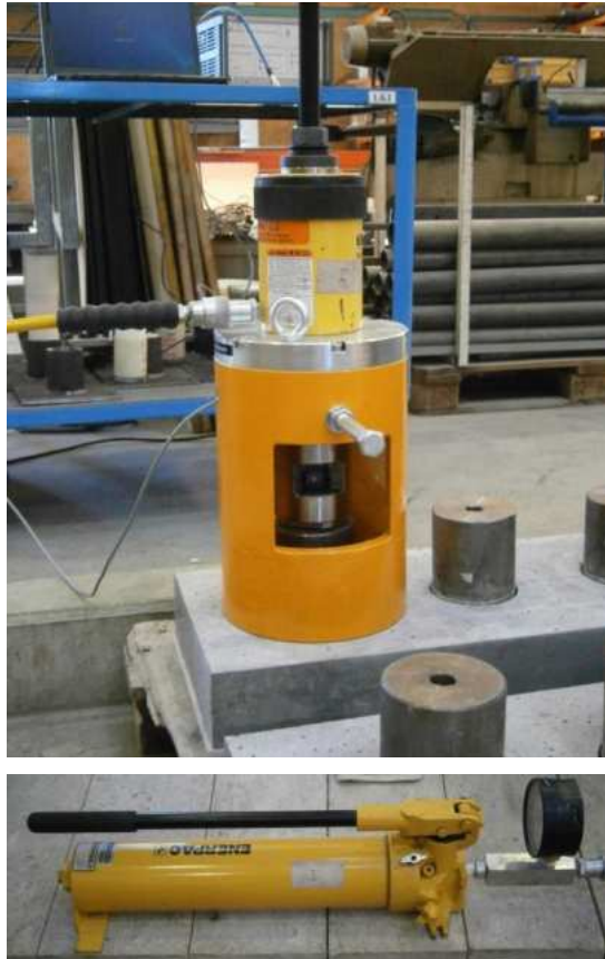
Abbildung D. 14: Hohlkolbenzylinder (oben) und Hydraulikpumpe (unten)
