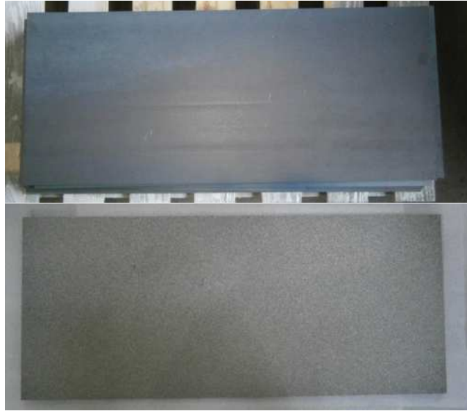
Abbildung D. 9: Stahlplatten vor (oben) und nach (unten) dem Sandstrahlen
