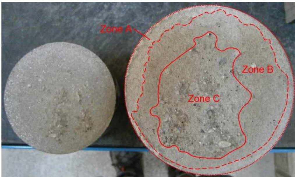
Abbildung D. 7: Bruchfläche Normalbeton
