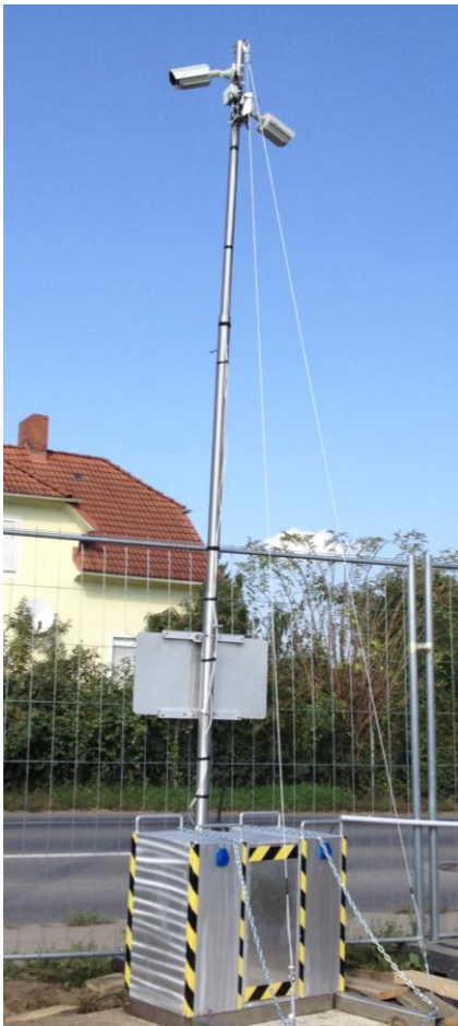
Abb. 25: Testaufbau MSdek-plus im Einsatz zur Verkehrsdatenerhebung Quelle: eigene Darstellung
