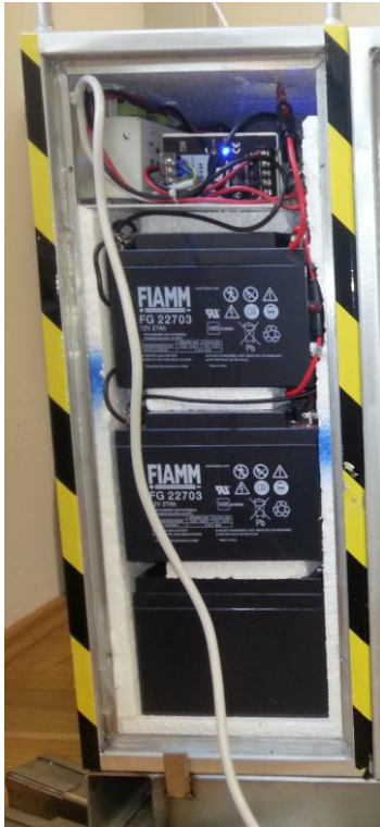
Abb. 28: Blei-Gel Akku-Box inkl. Laderegulierung für MSdek plus Testaufbau
