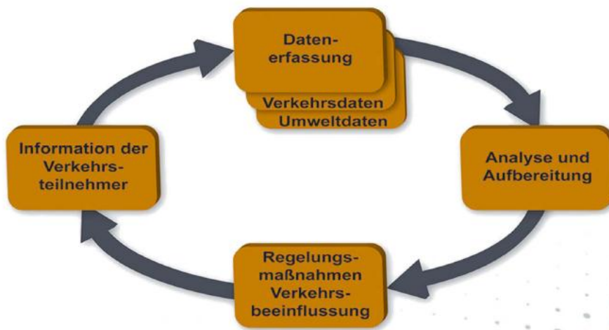
Abb. 9: Regelkreis des Betriebs einer VBA
