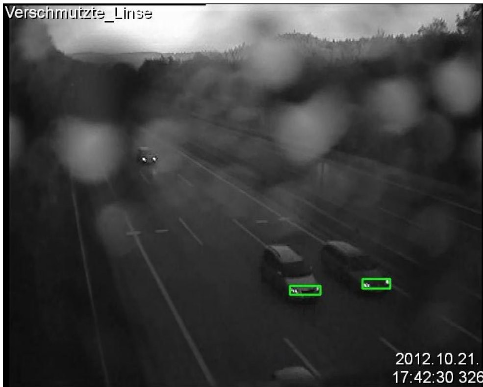
Abb. 41: Video: Aufnahme bei verschmutzten Scheiben
