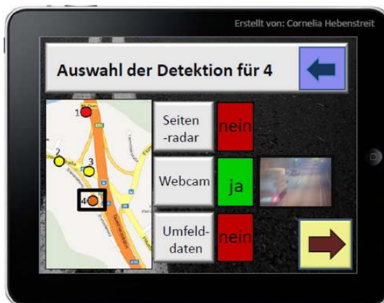
Abbildung 40: Auswahl lokaler Sensoren, die an der mobilen Anzeige aktiv geschaltet werden sollen
