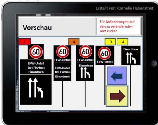
Abbildung 43: Schildertexte können noch angepasst werden und der Schilderinhalt wird graphisch und alpha-numerisch dargestellt
