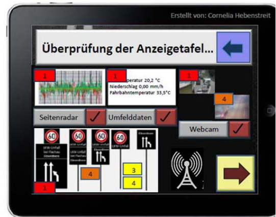
Abbildung 44: Azeigetafel wird mit Schilderinhalt und aktivierten Sensoren vollständig zur endgültigen Abnahme vor der Aktivierung präsentiert
