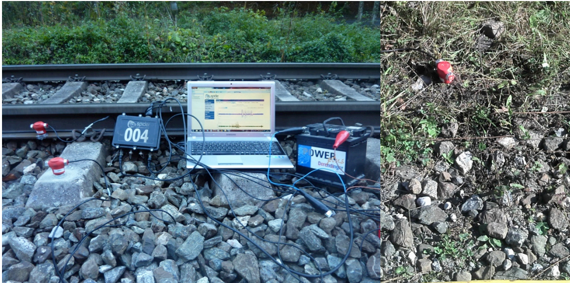
Abbildung 5: Übersicht über die Befestigung der Geophone am Gleis, am Schweller und in der Umgebung.
