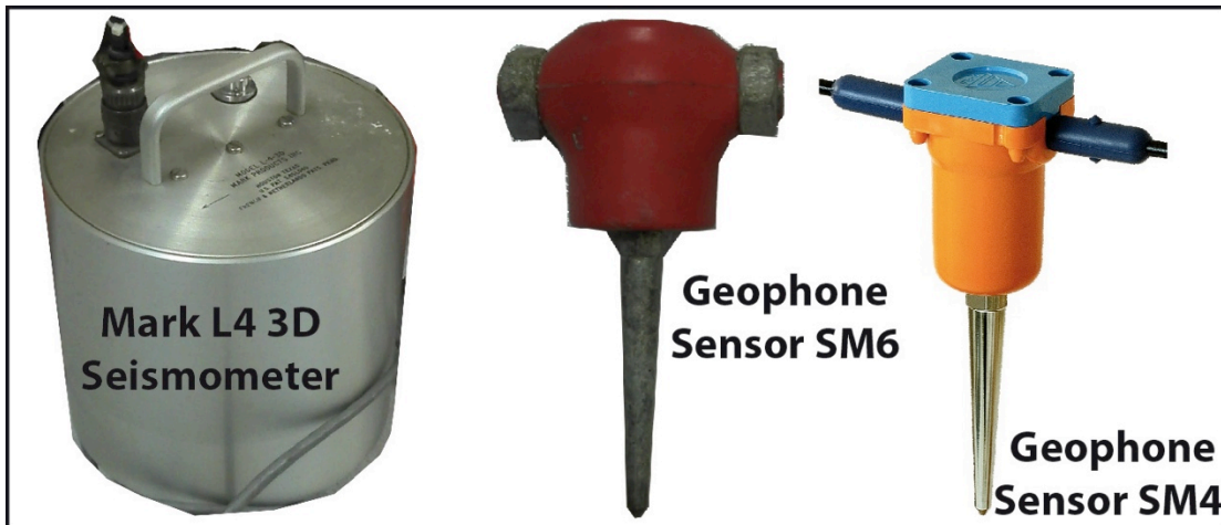
Abbildung 4: Überblick über derzeit am Markt erhältliche seismische Sensoren. Geophon Sensor SM6 (Bildmitte) wurde für diese Studie eingesetzt.
