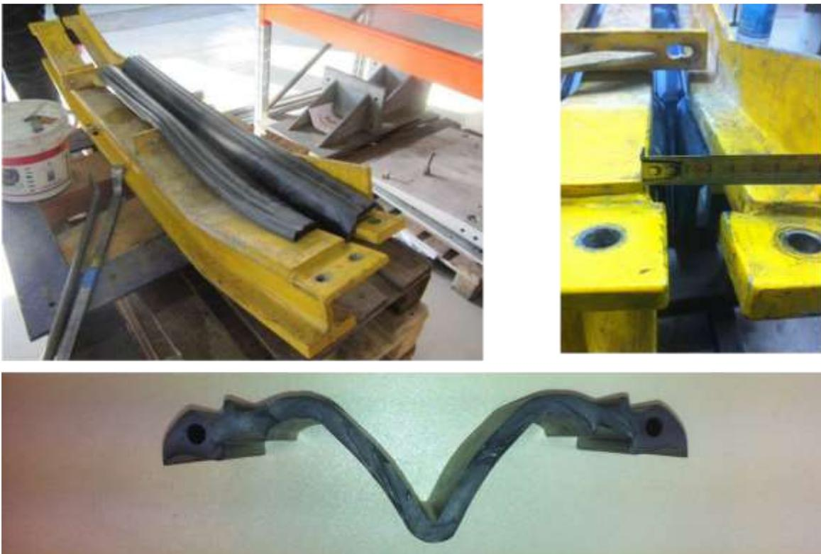
Abbildung 92: Testvorrichtung zur Dichtigkeitsprüfung von Dichtprofilen
