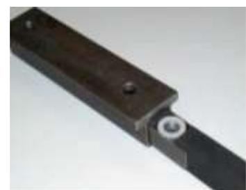
Abbildung 74: Bauteile des Schraubenkanals – Vergleichbar mit einer Schublade können die Muttern - durch Elastomere in Position gehalten – eingeschoben werden und sind somit austauschbar
