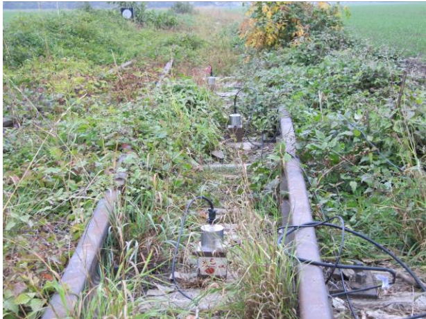
Foto 9. Erschütterungssensoren an den Schwellen eines aufgelassenen Gleises.
