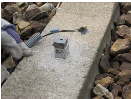
Foto 11. Beschleunigungssensor in der Mitte einer Betonschwelle
