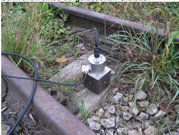
Foto 10. Wilcoxon und KAS Sensor auf einem Stahlwürfel zwecks Ankopplung.
