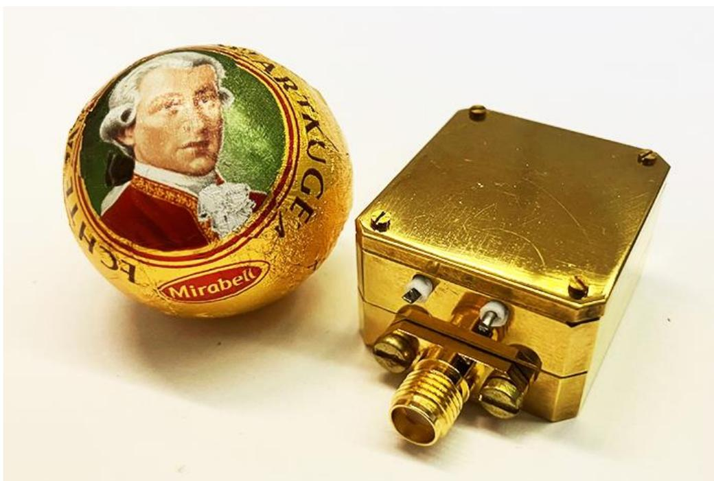
Quantenverstärker im Größenvergleich
