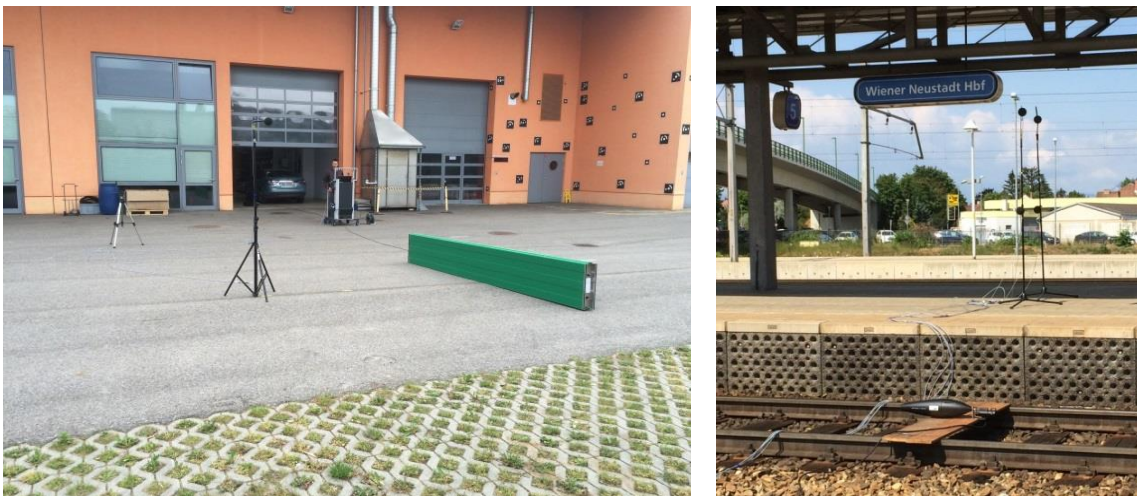
Abbildung 4: Testmessungen am AIT-Standort (links) und Validierungsmessungen an der absorbierenden Bahnsteigkante am Bahnhof Wiener Neustadt (rechts).
