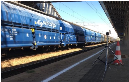
Abbildung 7: Beispielhafte Vorbeifahrten von einem Güterzug am Querschnitt „Bahnsteig mit Dach“ (links) und von einem Regionalzug am Querschnitt „Bahnsteig ohne Dach“ (rechts).
