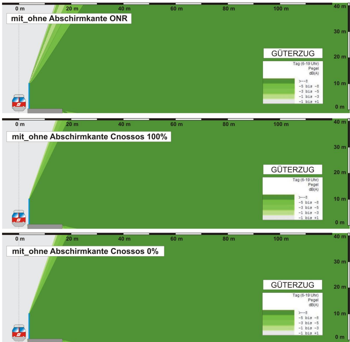
Abbildung 74: Pegeldifferenzen bei Annahme einer Abschirmkante an der Bahnsteigdachkante.
