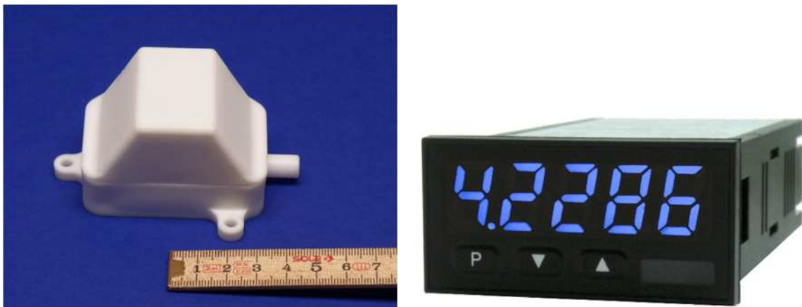
Abbildung 18: Dopplerradarmesszelle sowie Impulsmessgerät - Murgeschwindigkeit
