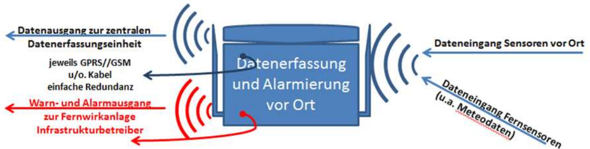
Abbildung 5: Datenfluss - dezentrale Datenerfassungs- und Alarmierungseinheit
