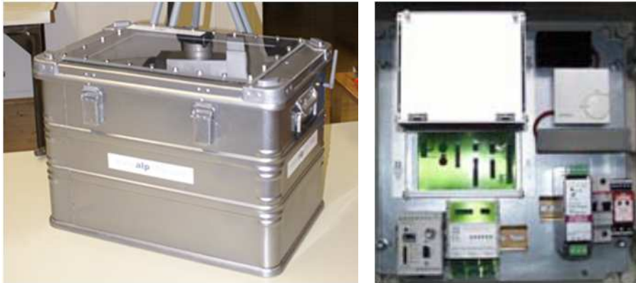
Abbildung 1: Messbox mit Touchscreen, Innenleben Datenerfassung, Verarbeitung, Alarmierung
