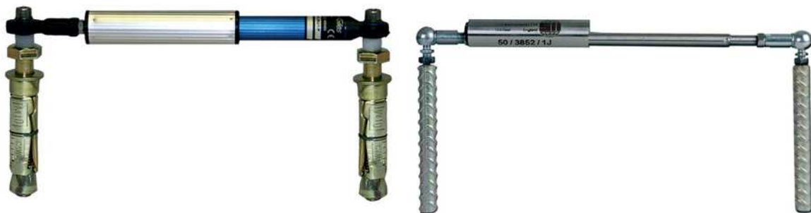
Abbildung 30: Rissmesser mit Montagebolzen (Potentiometer oder Schwingsaitensensor / Interfels)
