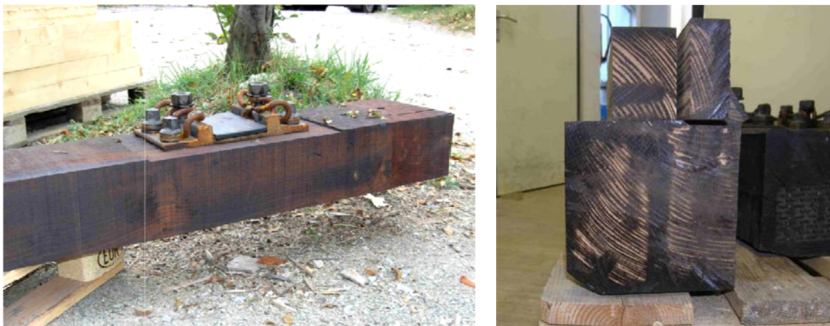
Abbildung 1: Teerölschwelle in der Übersicht (links) und querschnitten (rechts)
