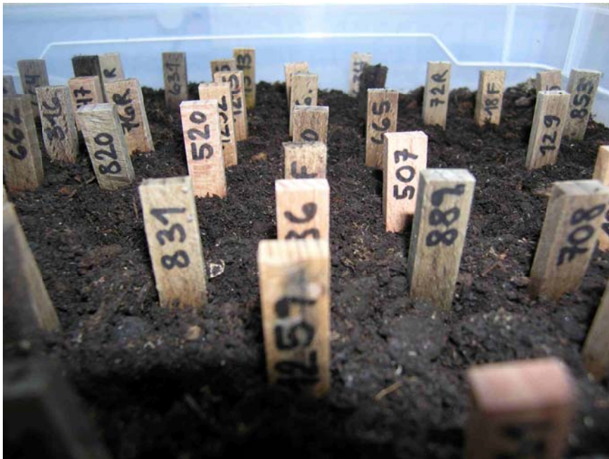
Abbildung 3: Beispiel der Versuchsmethode zur Untersuchung gegenüber Moderfäulepilzen
