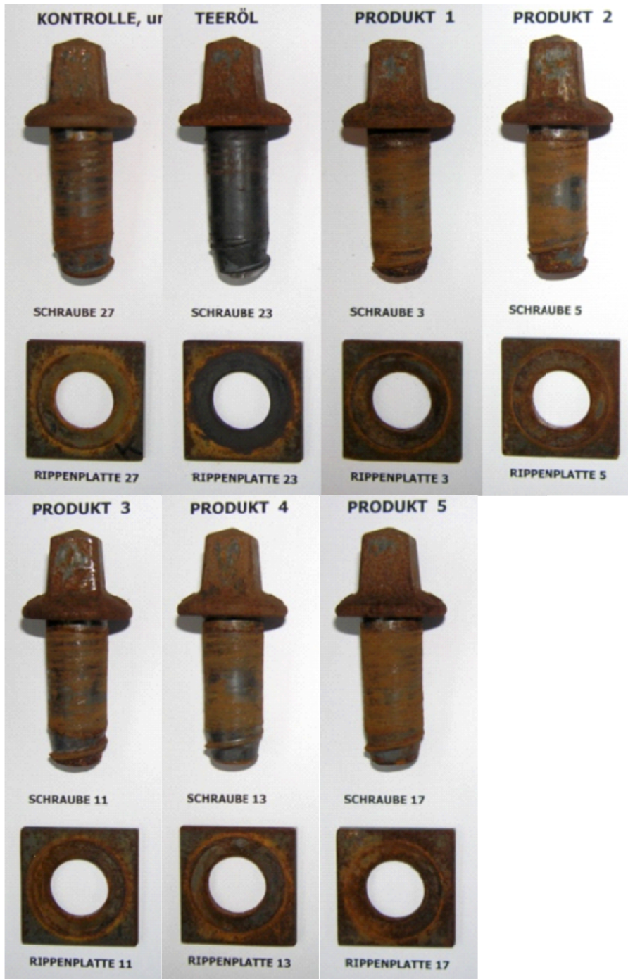
Abbildung 11: Schwellenschrauben und „Rippenplatten“ nach 6 Monaten Freilandexposition
