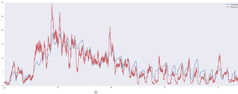
ABB 2. Verifikation des Regressionsmodells (rot) mit Messdaten des gemittelten Energieverbrauchs aller Weichenheizungsanlagen (blau) mittels Kreuzvalidierung
