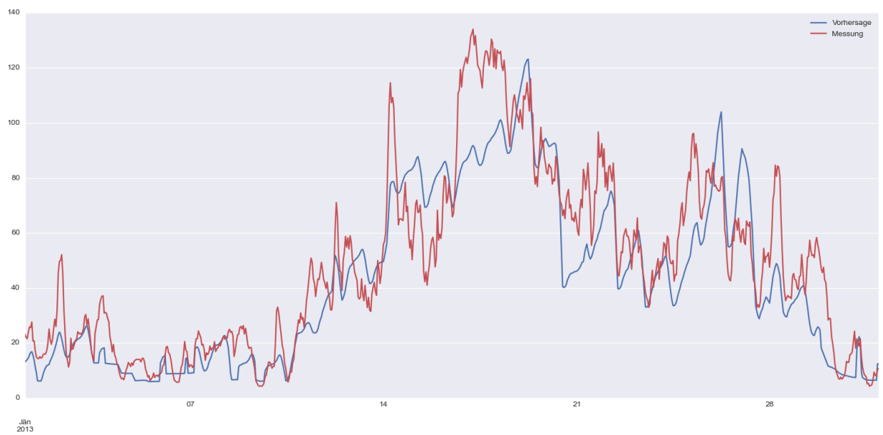
Abbildung 16: Vergleich des gemessenen Energieverbrauchs (rot) mit der Vorhersage des Regressionsmodells mit allen sechs Prädiktoren (blau) , oben im Dezember 2012, unten im Januar 2013
