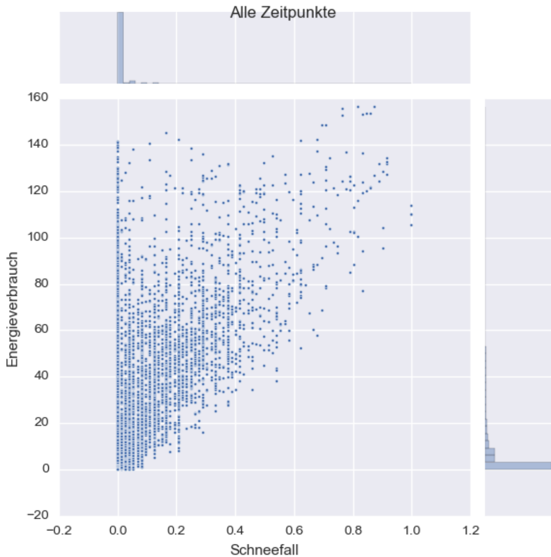
Abbildung 7: Scatterplot des Energieverbrauchs aller Weichenheizungsanlagen vs. über alle betrachteten Orte gemittelten binären Schneefallparameter (Schneefall ja = 1, Schneefall nein = 0)
