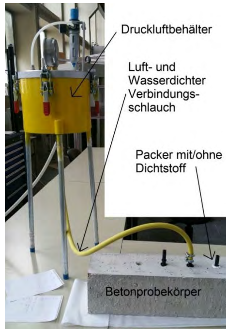
Abbildung 74: Versuchsaufbau zur Prüfung der Dichtigkeit
