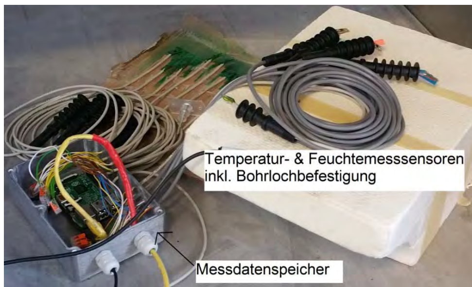
Abbildung 59: Übersicht Messeinrichtung vor Tunnelmontage
