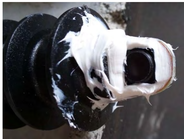
Abbildung 53: Abdichtung der Platine durch Dichtmittel
