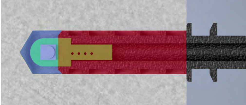
Abbildung 58: Schlagpacker für tiefere Messstufen (Blaue Fläche zeigt das Messvolumen, rote Fläche die effektive Dichtung).
