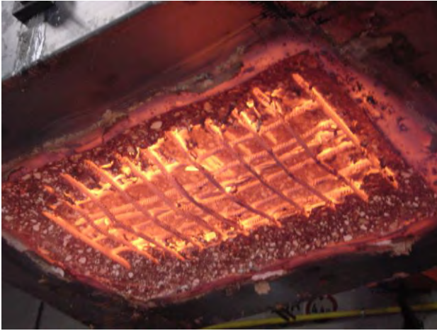
ABB 2. Beispielhafte Abplatzungen an Brandversuchsplatte
