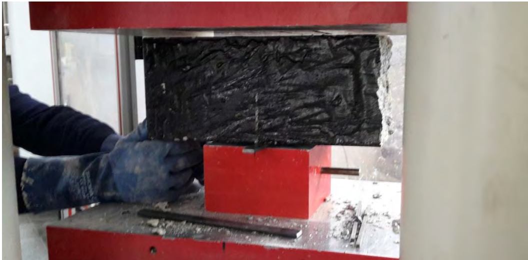
Abbildung 104: Versuchsaufbau beim Spalten in der Prüfmaschine
