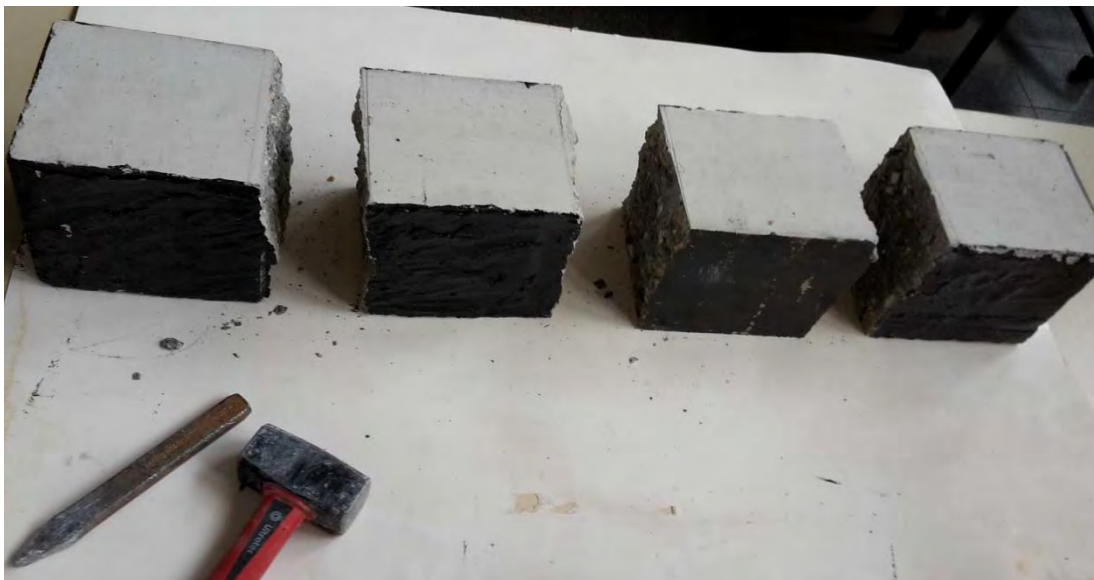
Abbildung 105: Gespaltener Probekörper mit Hammer und Meißel
