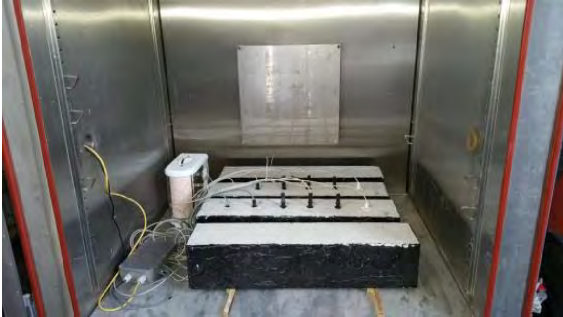
Abbildung 83: B1, B2, 2 Referenzbalken und Hygrometer in der Klimakammer
