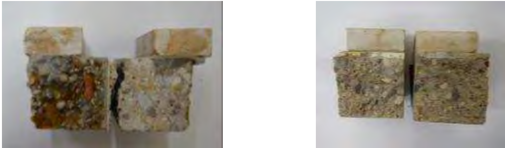
Abbildung 141: Bruchbild von Nr1_IG_UG04_schwarz (nach XF4) nach der Keilspaltprüfung
