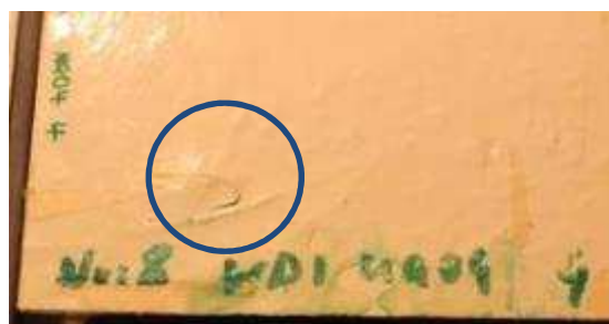
Abbildung 118: Nr8_WDI_UG04_4_grün nach der XF4-Belastung
