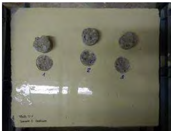
Abbildung 140: Platte 3_1 nach der Prüfung der Haftzugfestigkeit
