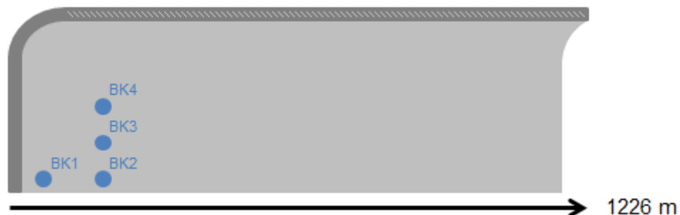
Abbildung 67: Beprobung Flirscher Tunnel - RFB Arlberg
