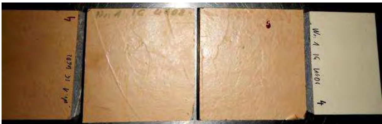
Abbildung 128: Probplatten nach thermischer Behandlung (4 Wochen bei 140 °C)
