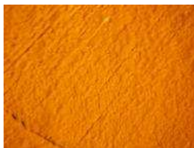
b) Anstrich etwas spröder, leichtes Abplatzen nach Messer-Ritztest
