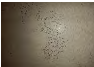
a) Verschmutzung durch Unebenheit der Beschichtung
