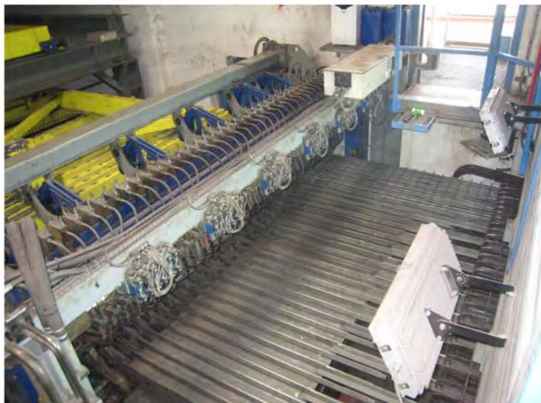
**Abbildung 3.49: Herstellung der Stahlmatten**
