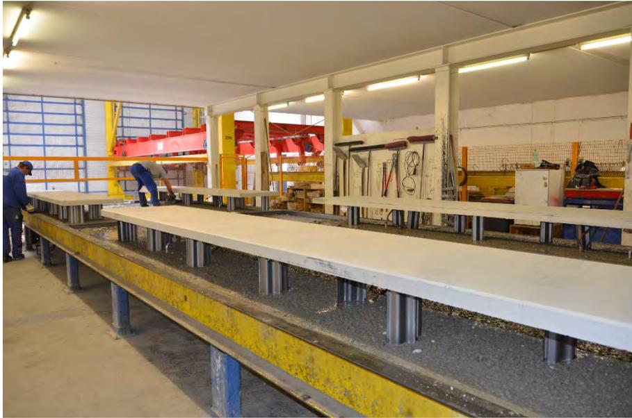
**Abbildung 3.53: Doppelwandelemente werden nach dem Verdichten und vor dem Transport zur Aushärtung noch abgemessen**
