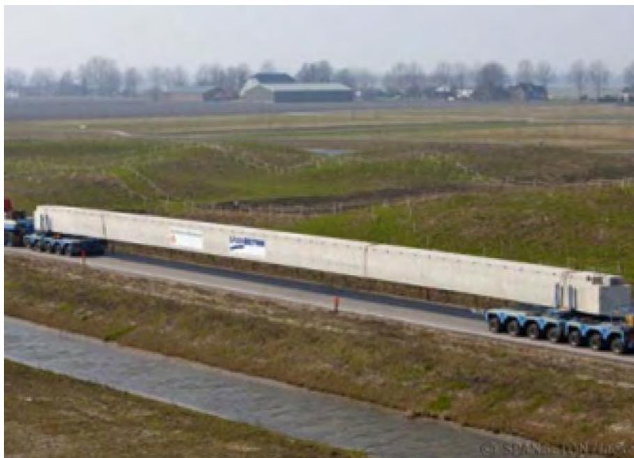
**Abbildung 2.45: Brückenträger während des Transports [15]**
