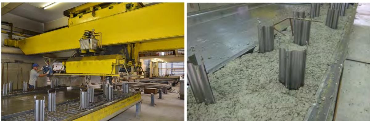
**Abbildung 3.51: Betonieren (links) und Rütteln (rechts) der ersten Schale der Doppelwände für die Versuchsträger**
