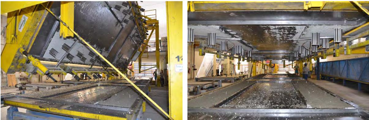
**Abbildung 3.52: Wenden der zweiten Doppelwandschale (links); Zusammenführung der zwei Doppelwandschalen (rechts)**
