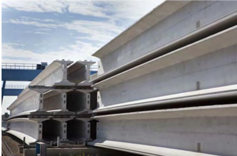
**Abbildung 2.44: Gelagerte Betonfertigteile [10]**
