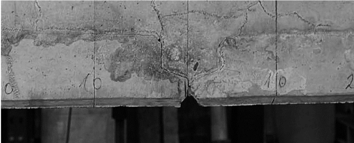
**Abbildung 3.31: Ausbetonierte schlaff bewehrte Fuge**
