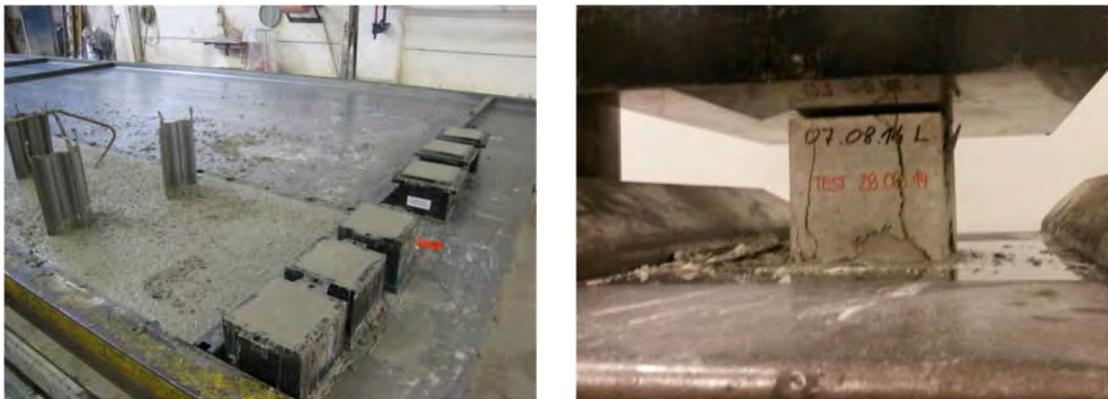
**Abbildung 3.45: Würfeldruckversuchskörper: Herstellung (links) und nach einem Würfeldruckversuch (rechts)**
