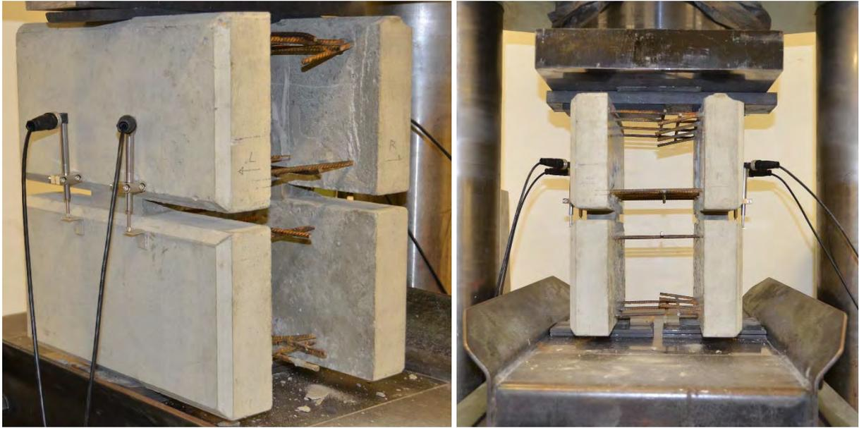
**Abbildung 3.27: Druckversuche an den neuentworfenen Fugen für vorgespannte Träger**
