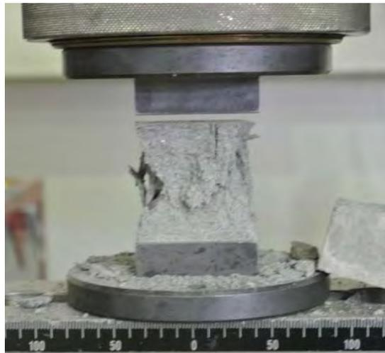
**Abbildung 3.16: Druckbruchfigur Mörtel 1 bis 5**
