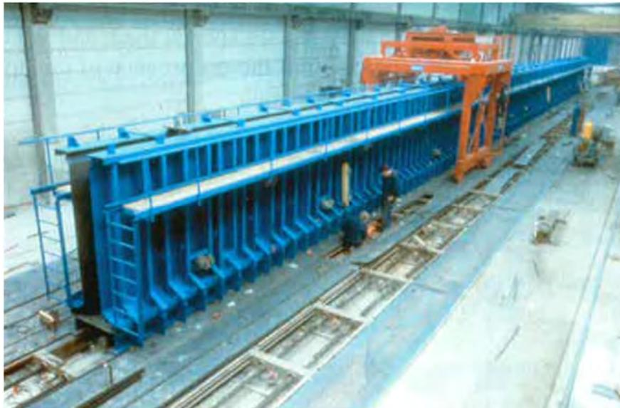
Abbildung 2.43: Herstellung eines Betonträgers im Fertigteilwerk [10]
