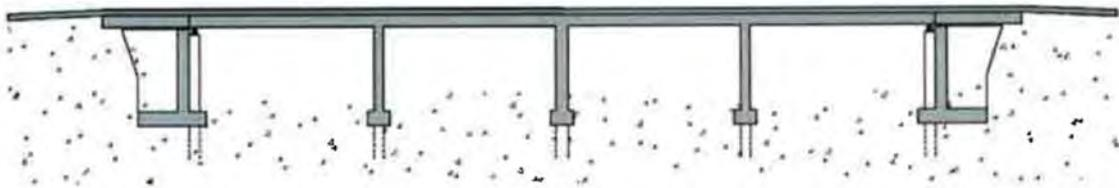
**Abbildung 2.3: Fugenlose semi-integrale Brücke [5]**
