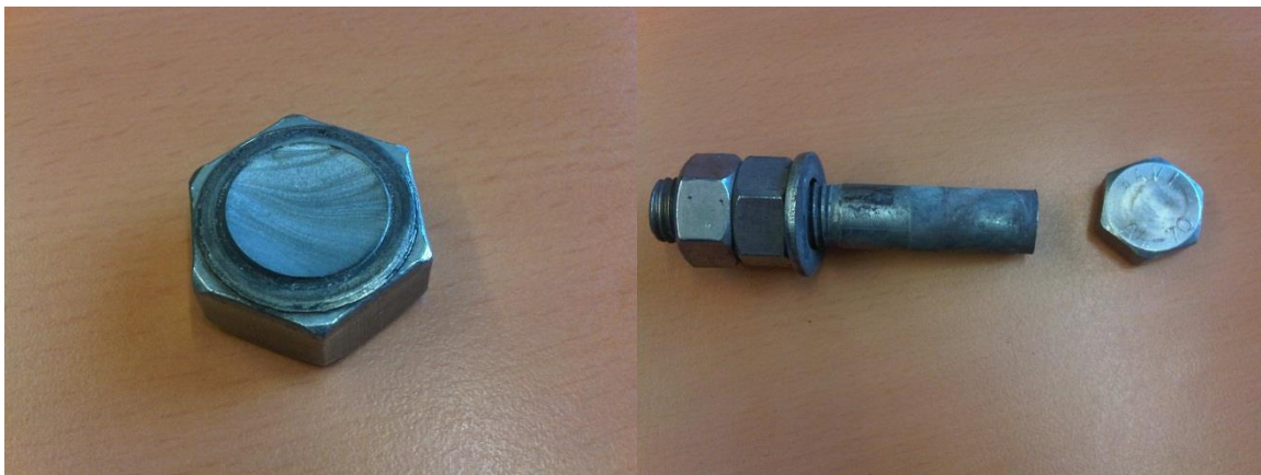
Abb. 2-15. Gebrochene Schraube. Fotos: [34]
