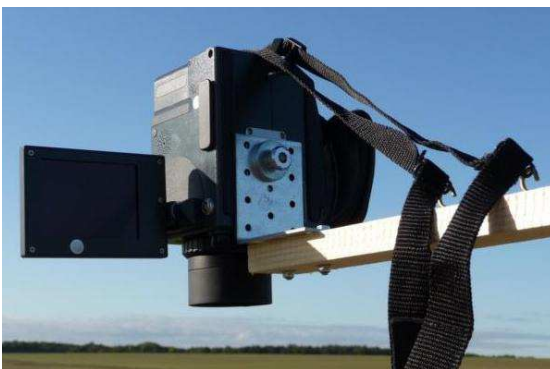
Abbildung 32. Messbereite Position der Thermografiekamera (links), Wasserwaage mit Winkelmesser (rechts).
