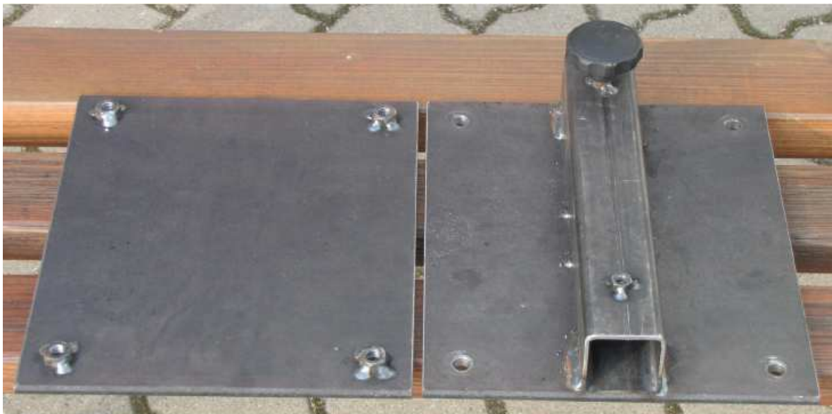
Abbildung 74. Stahlbleche als Klemmbefestigung.
