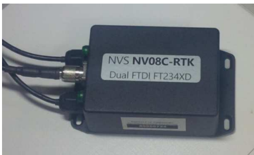
Abbildung 59. GNSS Empfänger NV08C-RTK (NVS Technologies AG).
