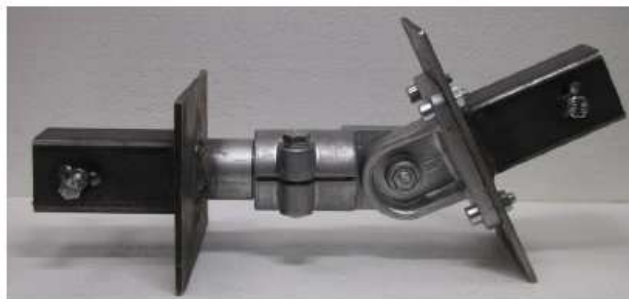
Abbildung 76. Gelenk zur Ausrichtung der Thermografiekamera (links), Thermografiekamera mit Weitwinkelobjektiv (rechts).
