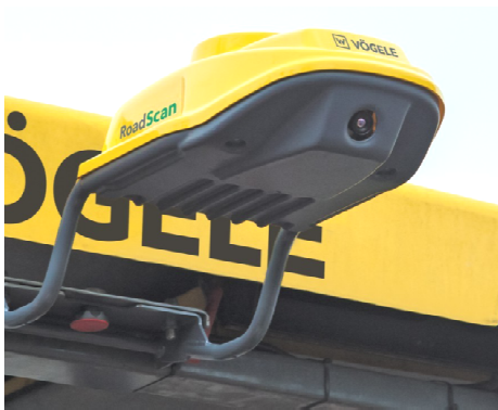
Abbildung 17. System RoadScan der Joseph Vögele AG (Vögele, 2016).
