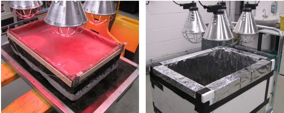
Abbildung 41. Erwärmung der Asphaltprobenplatte mittels Infrarotlampen (links); Asphaltplatte unter Wasserfläche (rechts).
