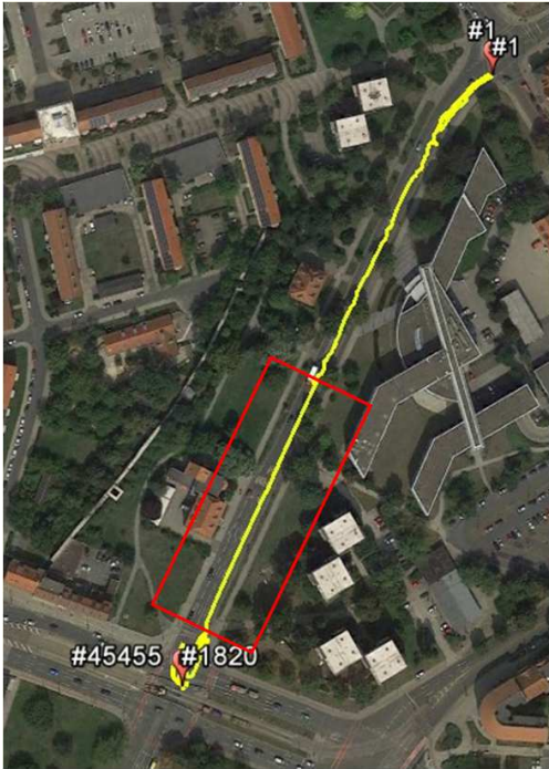
Abbildung 93. Trajektorie der GNSS-Aufzeichnungen und der zur Auswertung herangezogene Abschnitt (rot) der Baumaßnahme B83.
