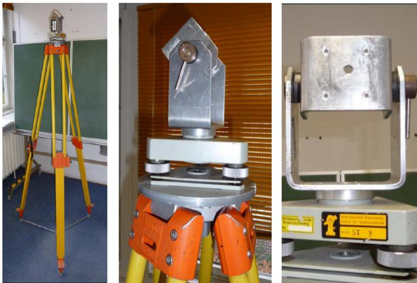
Abbildung 30. Stativ mit Dreifuß, Kippaufsatz und Stativspinne (links), Dreifuß und Kippaufsatz im Detail (Mitte), Bohrloch zur Befestigung der Thermografiekamera im Kippaufsatz (rechts) (Wistuba & Lorenzl, 2012).
