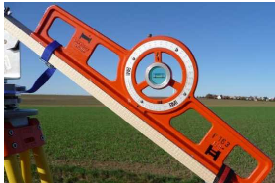
Abbildung 32. Messbereite Position der Thermografiekamera (links), Wasserwaage mit Winkelmesser (rechts).
