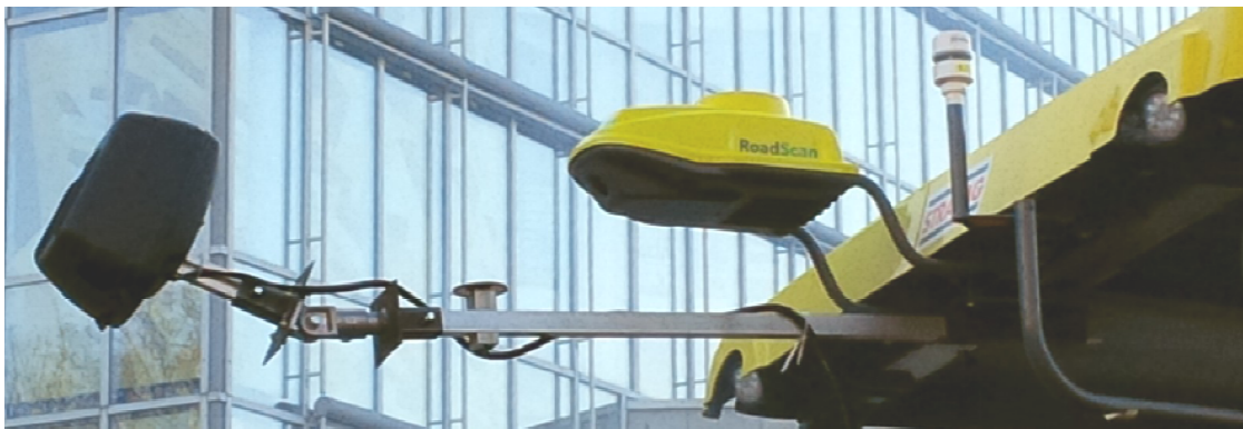
Abbildung 55. Montierte Thermographiekamera in Schutzeinhausung am Kragarm (links) und RoadScan der FA Vögele am Fertiger.
