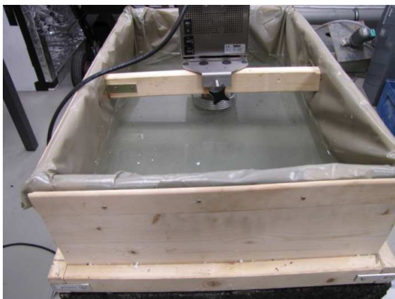
Abbildung 42. Homogenes Erwärmen einer Asphaltplatte im Wasserbad.
