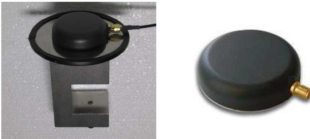
Abbildung 58. Montagevorrichtung mit GNSS Antenne (links), GNSS Antenne (rechts).
