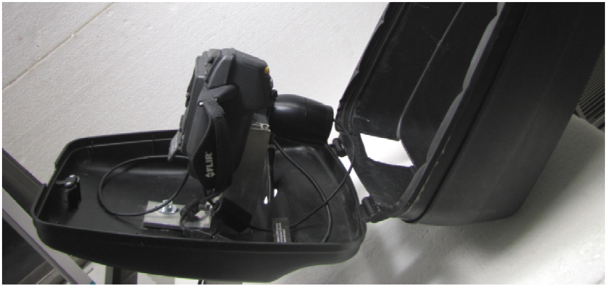
Abbildung 77. Montierte Thermografiekamera in Schutzeinhausung.
