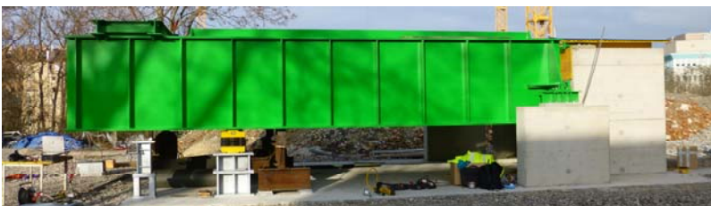
ABB 1. Versuchsanlage zur Ermittlung der dynamischen Kennwerte des Schotteroberbaues mit der Möglichkeit zur Modifikation der Federlager hinsichtlich Position und Steifigkeit zur Abdeckung eines möglichst großen Frequenzbereichs bei den Untersuchungen
