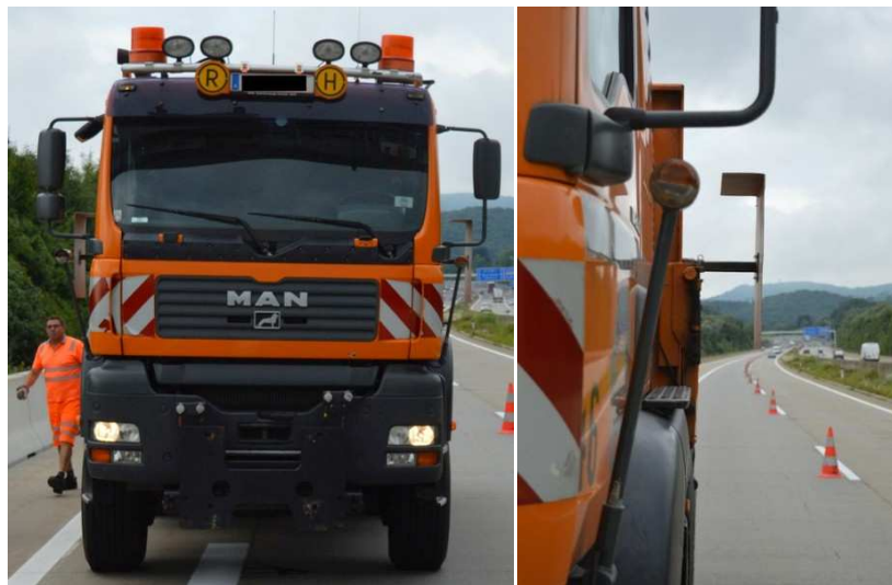
Abbildung 18: Messaufbau Fahrzeug mit 3m Breitemodul
