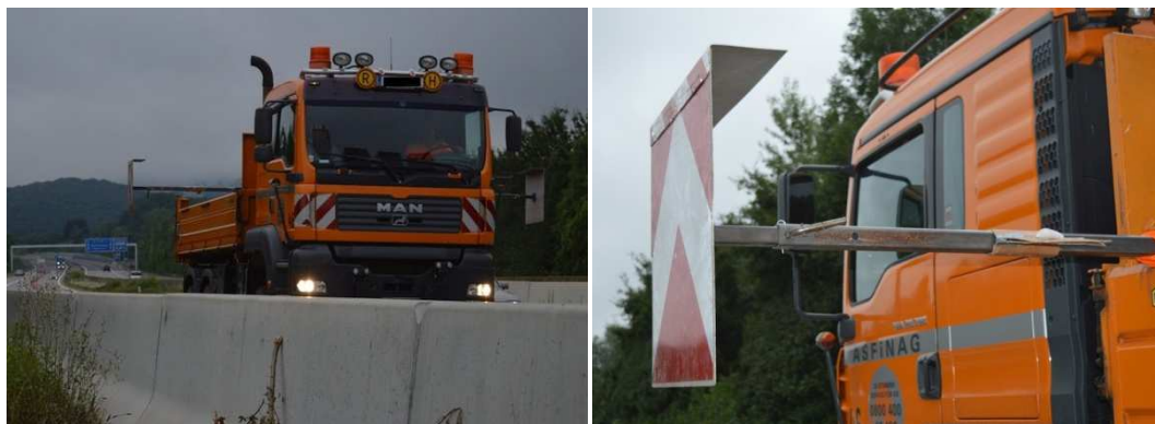
Abbildung 19: Messaufbau Fahrzeug mit 5m Breitemodul
