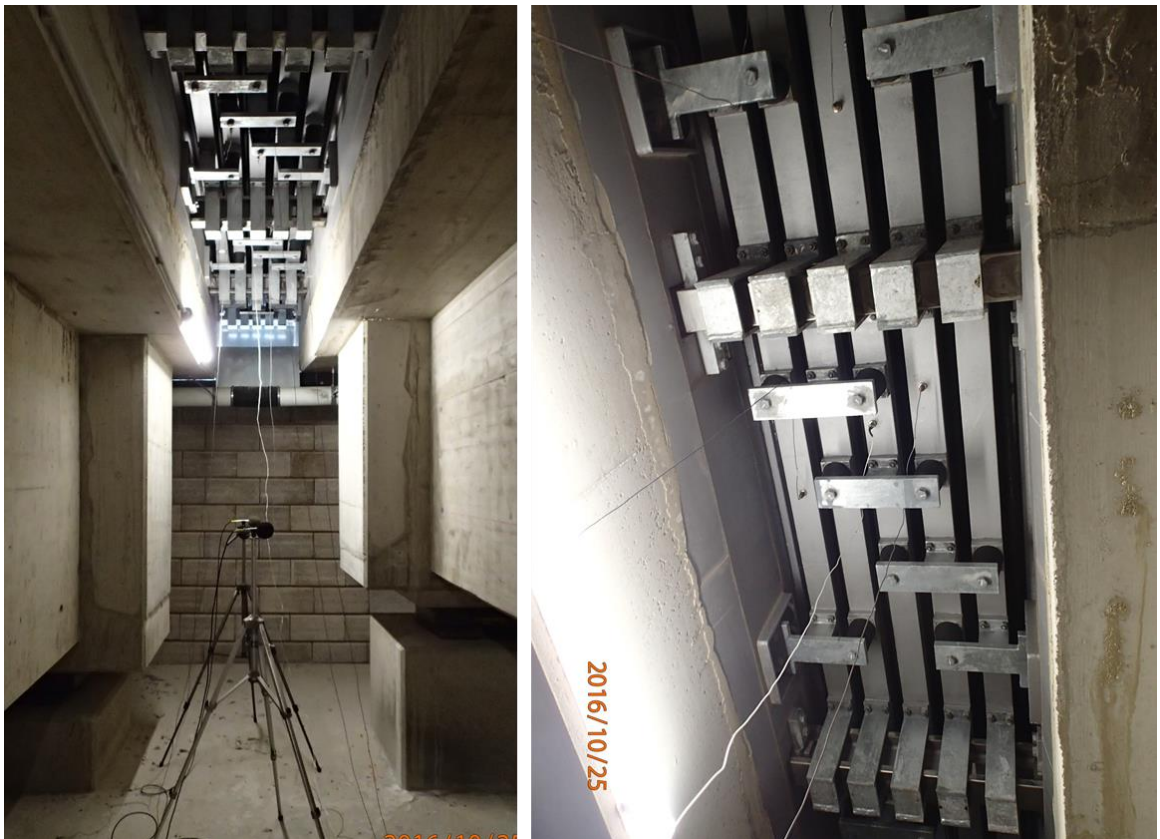
Abbildung 5-26: Aufbau Luftschall- und Erschütterungsmessung.
