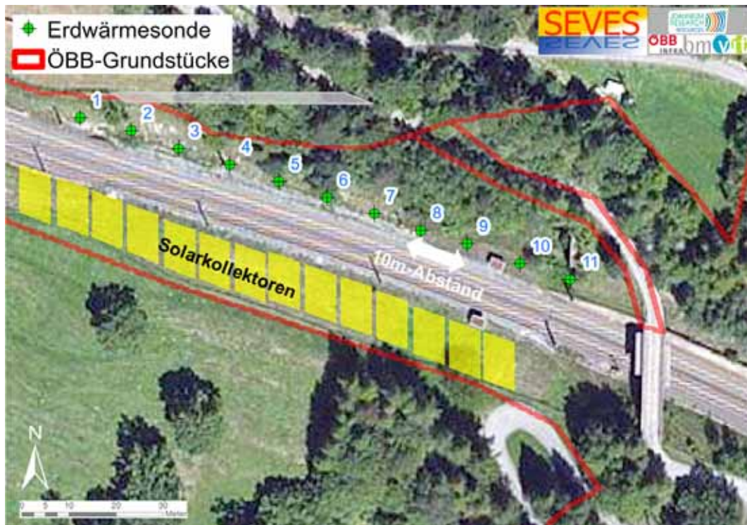
Abbildung 105: Lageplan der Gesamtanlage - Verkehrsstation Oberfalkenstein
