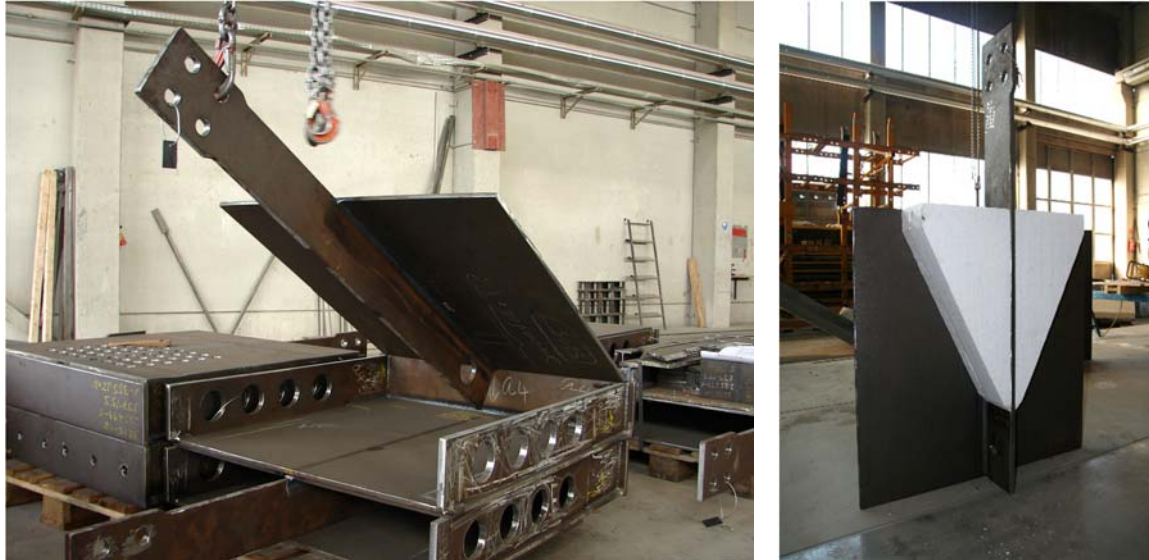
Abbildung 9: Vorversuchskörper; links: Teil-Querschnitte aus Stahl des QS-Typs 1 vor der Betonage des Betonkerns (Bildausschnitt links: Teil-QS mit gelochtem Deckblech); rechts: oberer Teil-Querschnitt eines QS-Typ 1b-Versuchskörpers
