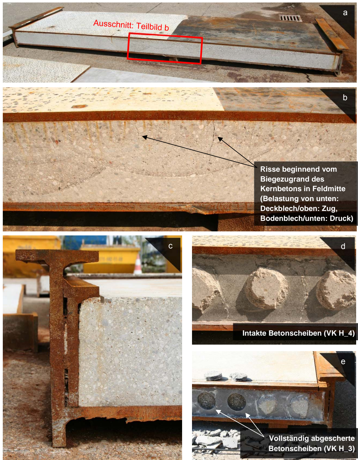
Abbildung 46: Geöffnete SCSC-Hauptversuchskörper; Teilbilder a und b: abgetrennter Teil von Versuchskörper H_4 (QS-Typ 1) mit Biegezugrisse im Betonkern in Feldmitte; Teilbild c: Detailansicht des Auflagerbereiches eines Längsschnittes von H_3 (QS-Typ 2); Teilbild d: intakte Betonscheiben bei Versuchskörper H_4 (QS-Typ 1); Teilbild e: vollständig abgescherte Betonscheiben bei Versuchskörper H_3 (QS-Typ 2)
