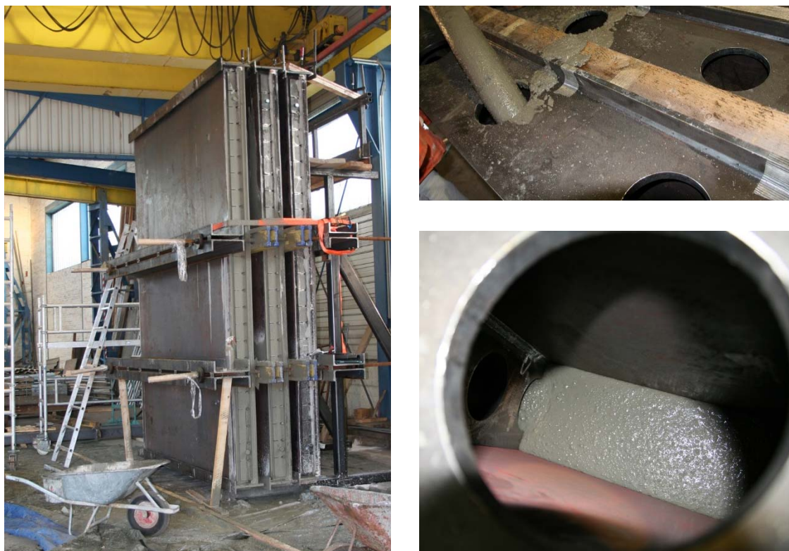
Abbildung 29: Betonage der SCSC-Hauptversuchskörper der Serie A; links: temporär verspannte und aufgestellte Hauptversuchskörper; rechts oben: Betonage mit Betonpumpe und Schlauch; rechts unten: Blick ins Innere eines QS-Typ 1-Versuchskörpers durch eine Betonieröffnung eines Endbleches
