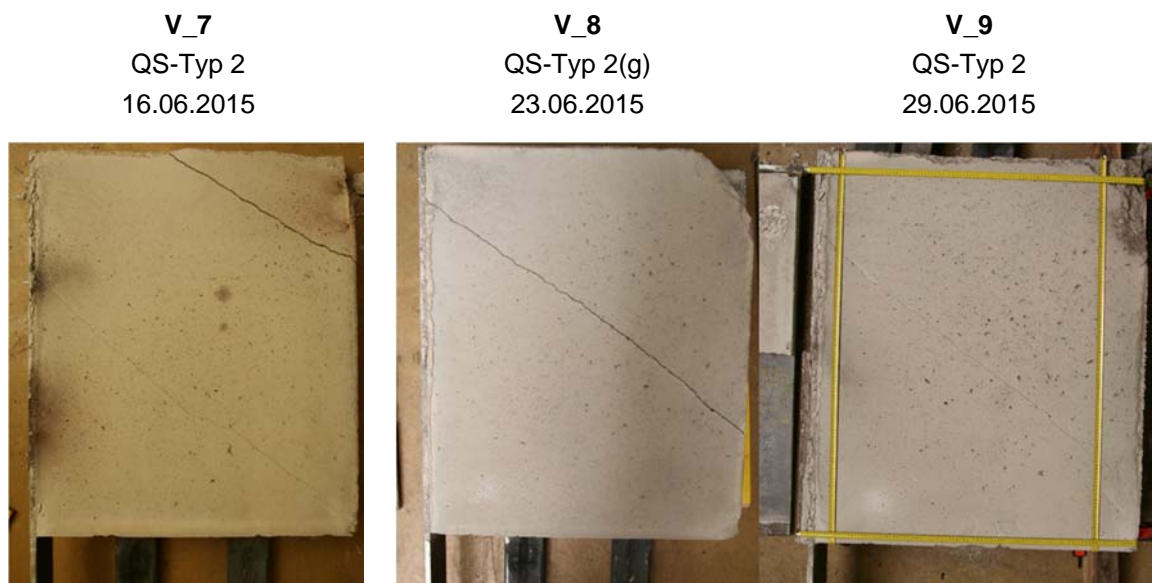
Abbildung 20: Untersichten der Betonkerne der geöffneten QS-Typ 2-Vorversuchskörper
