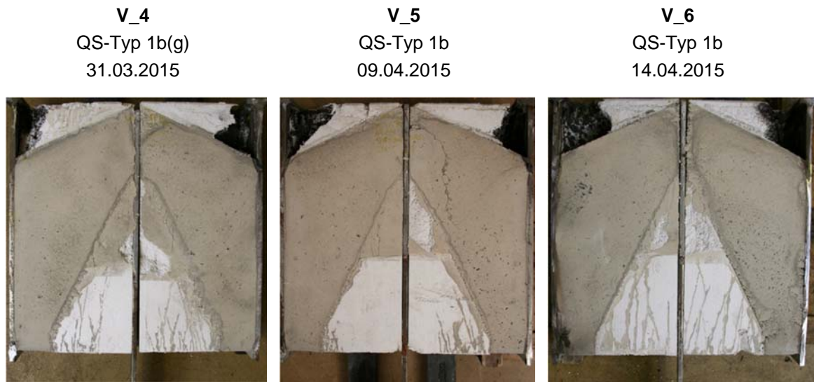
Abbildung 19: Untersichten der Betonkerne der geöffneten QS-Typ 1b-Vorversuchskörper
