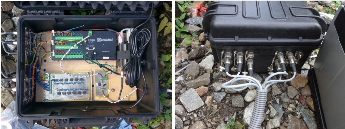
Abbildung 1: Innen- und Außenansicht des mobilen Detektionssystems im Testeinsatz
