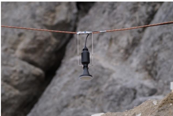
Abbildung 27: einfach abgespannter Radar-Pegelsensor
