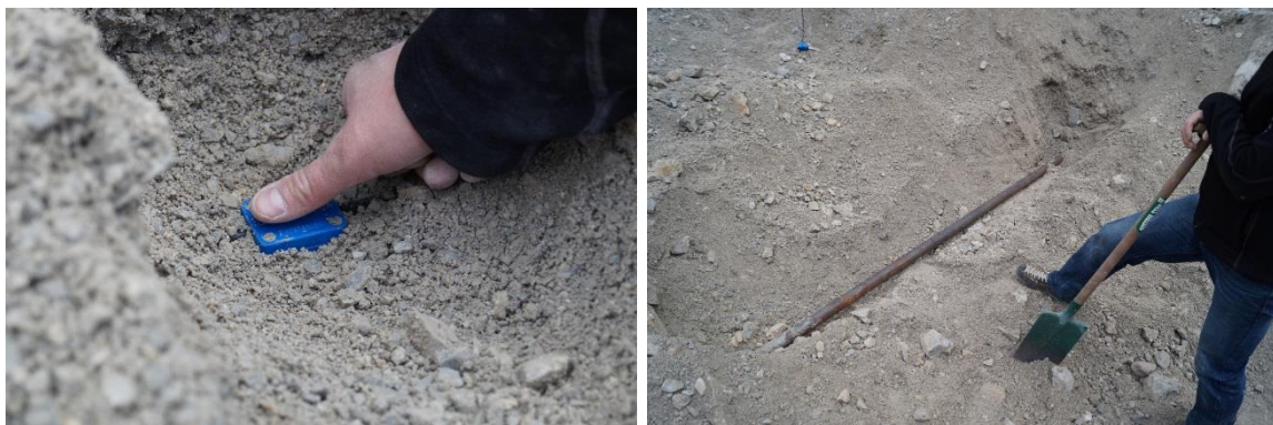
Abbildung 15: Geophon vergraben sowie Schwelle für die Anregung des zweiten Geophons
