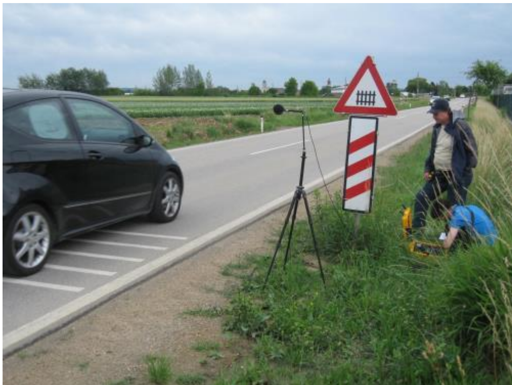
Abbildung 34: Anordnung der Anlage der Messung mit statischer Methode
