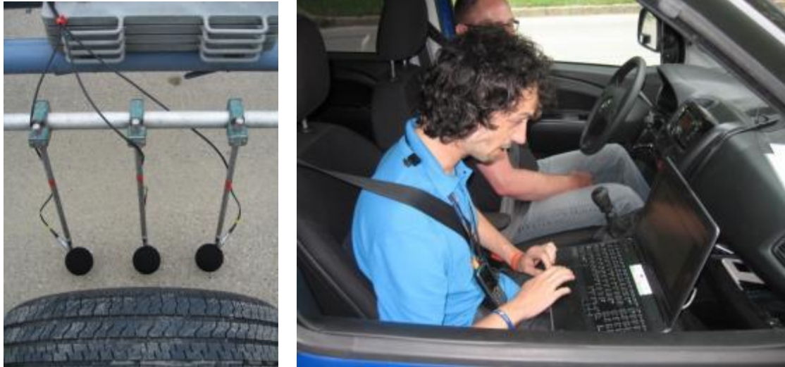
Abbildung 29: Messfahrzeug – Details der Meßtechnik (Meßmikrophone und Datenspeicherung)
