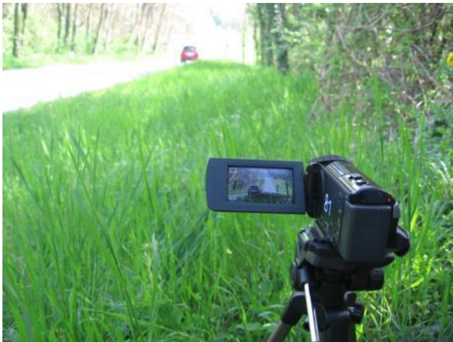
Abbildung 19: Videobeobachtung der Fahrspur und des Bremsverhaltens
