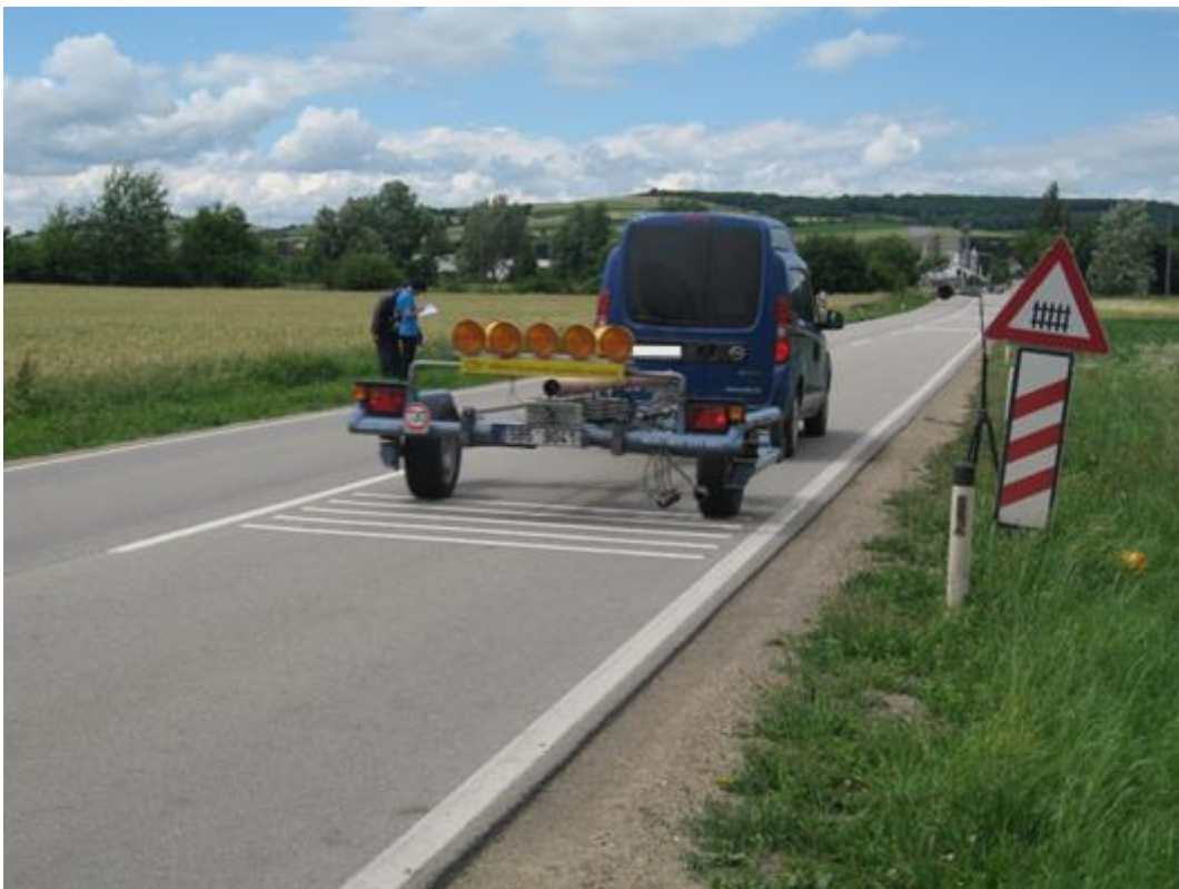
Abbildung 28: Messfahrzeug bei der Überfahrt der Rüttelstreifen
