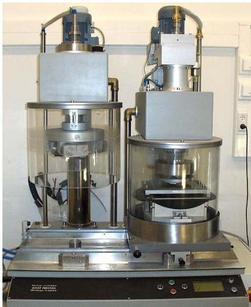
Abb. 2: Links Prüfanlage nach Wehner / Schulze PWS: links die Polierstation, rechts die Prüfstation. Rechts die erfasste Messwertkurve, der Schnittpunkt der geglätteten Kurve (rot) mit der 60 km/h-Linie = \mu_{PWS} .
