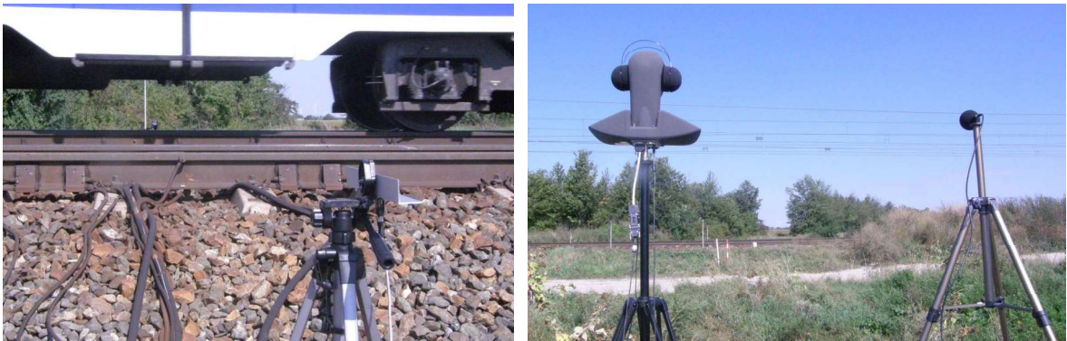
Abb. 2-8: Testmessung am 11. Sept. 2013 (links: Lichtschranke LS; rechts: Kunstkopf KK etwa 2,5 m über Gelände, ergänzt um konventionelles Mikrofon)
