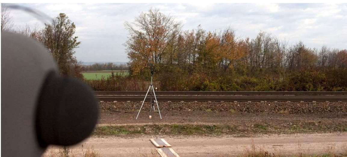
Abb. 2-12: freie Schallausbreitung in Messquerschnitt MQ2 nachdem der Bahndamm am 23. Okt. 2013 abgetragen wurde
