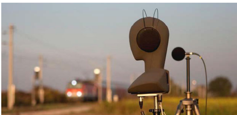
ABB 1. Binaurale Erfassung der Schallimmissionen mit Kunstkopfmesssystem
