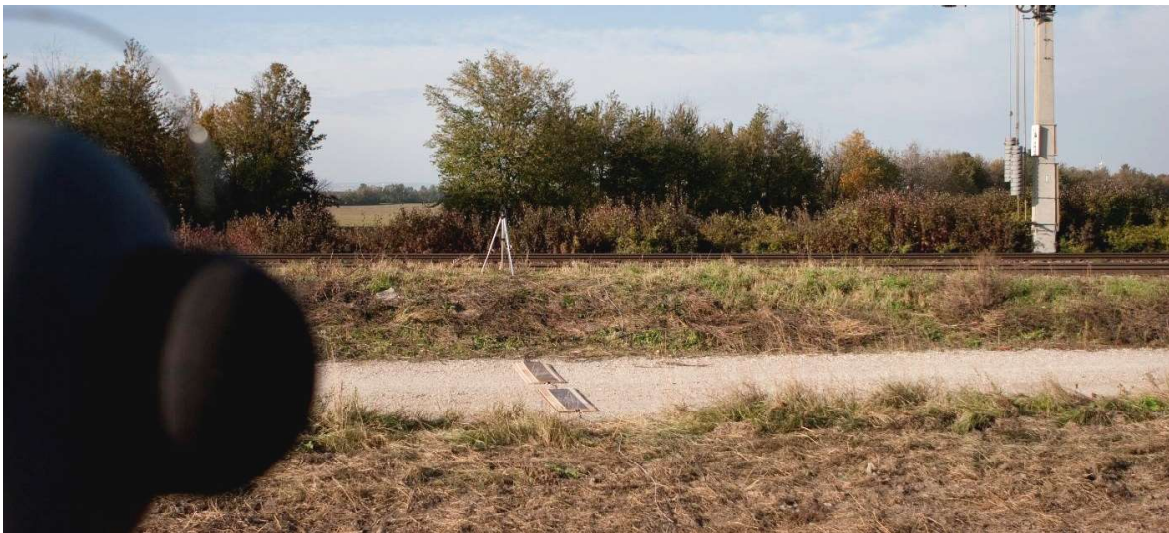
Abb. 2-11: Erhöhter Bereich des Bahndamms verhindert im Messquerschnitt MQ2 eine direkte Schallausbreitung vom Rad-Schiene Kontakt bzw. der Schiene zum Immissionspunkt in 25 m Entfernung
