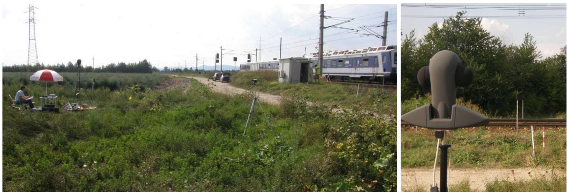
Abb. 2-7: Testmessung am 30. Aug. 2013 (links: gesamter Messaufbau; rechts: Kunstkopf KK in Messquerschnitt MQ1b)
