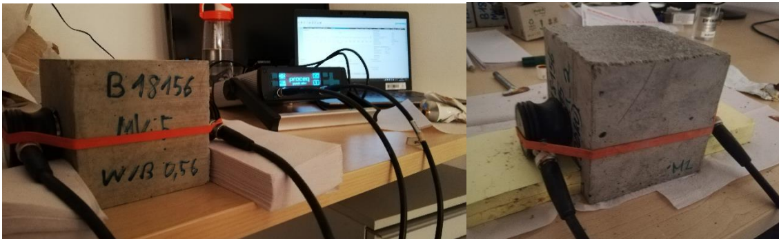
Abbildung 22: Messaufbau der Ultraschallmessungen mit direkter Anordnung der Scherwellenköpfe
