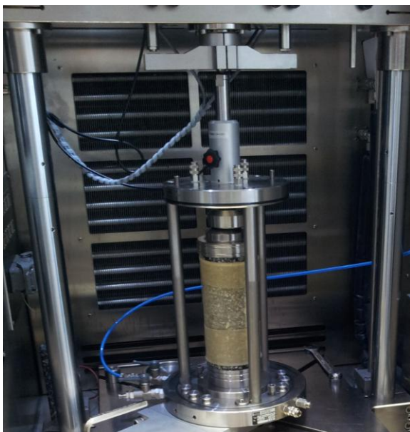
Abbildung 19: Für die Triaxialversuche verwendeter Prüfeinsatz (ohne Mantelaufsatz).
