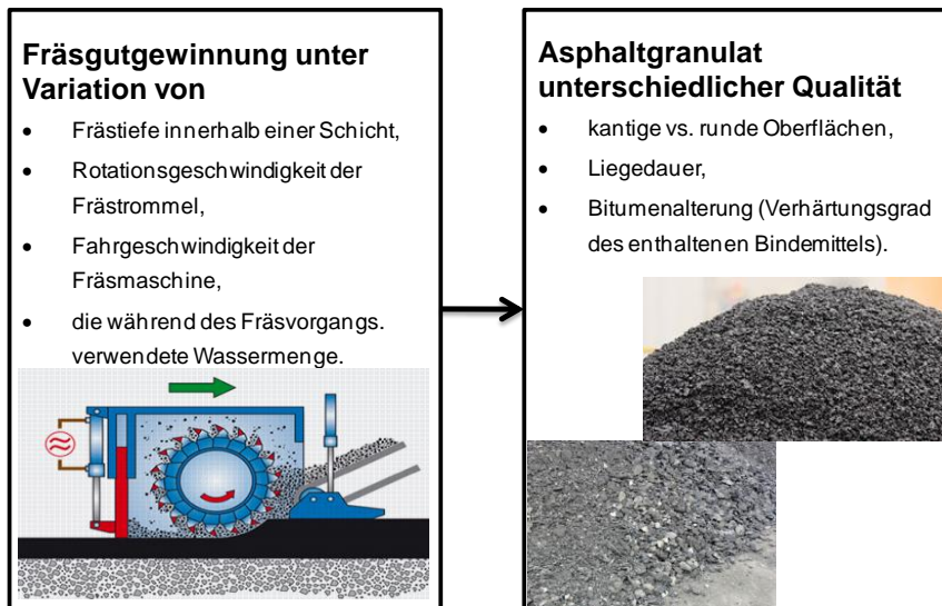
Abbildung 8: Variationsfaktoren bei der Gewinnung von Altasphalt zur Weiterverwendung als Asphaltgranulat in neuen Asphaltsschichten.
