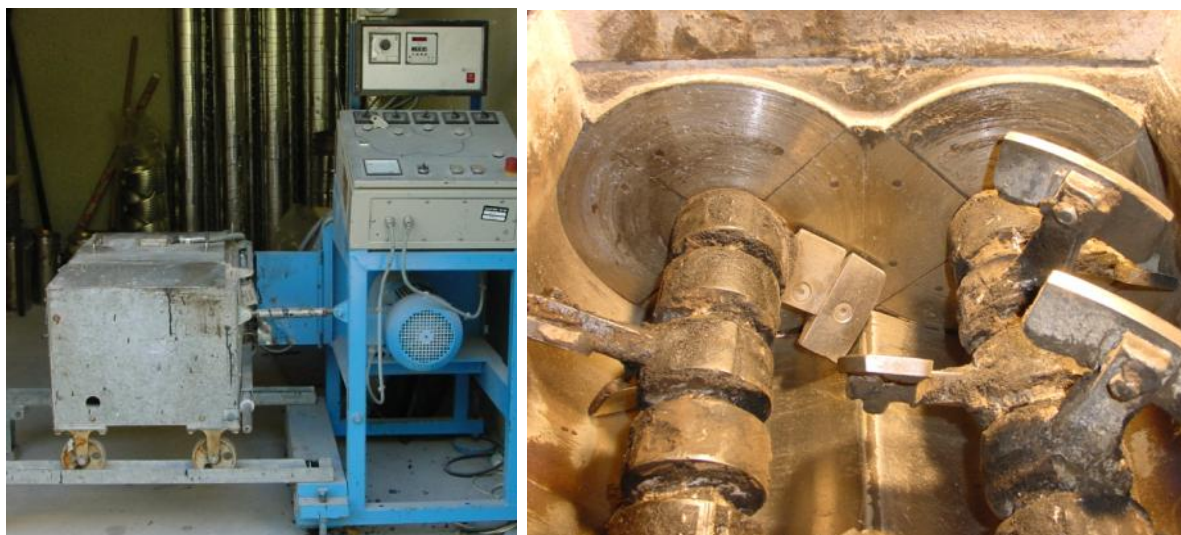
Abbildung 9: Doppelwellen-Zwangsmischer (im Prüflabor des ISBS) zur praxisadäquaten Herstellung von Asphaltmischgut unter Zugabe von Asphaltgranulat (links); Detail Mischwerkzeug nachempfunden dem Mischwerk in einer Asphaltmischanlage im Maßstab M = 1:8 (rechts).
