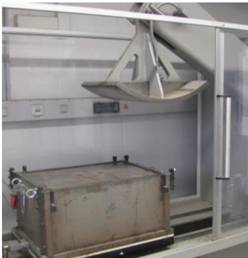
Abbildung 12: Walzsektor-Verdichtungsgerät zur Herstellung großformatiger Asphalt-Probekörper (links), Gewinnung von zylindrischen Asphalt-Probekörpern aus einer Asphalt-Probekörperplatte durch senkrechtes Bohren (rechts).
