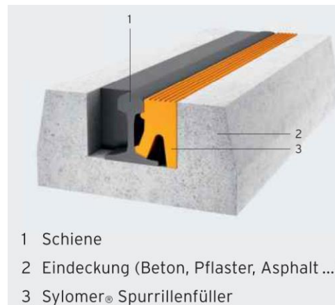
Abb. 7-3: künstlich erzeugte und mit elastischem Element ausgefüllte Spurrille 6
