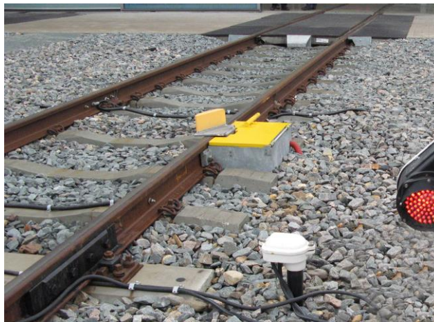
Abb. 2-9: klappbarer Sperrschuh in Amsterdam, Niederlande (vgl. [12])
