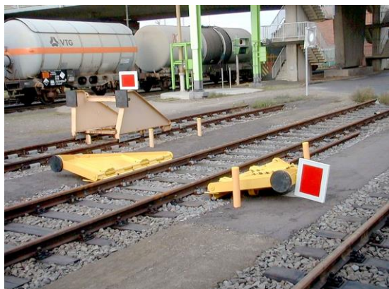
Abb. 2-13: Klappbarer Bremsprellbock – deaktiviert – Dormagen (vgl. [16])
