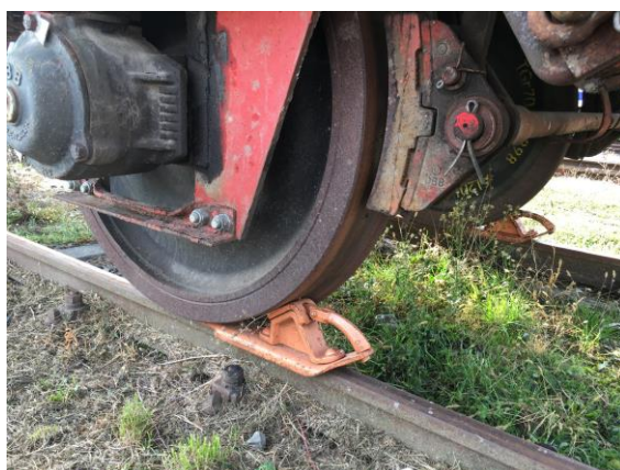
ABB 1. Eine der bisherigen Absicherungsmethoden mittels Hemmschuh
