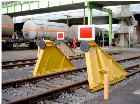
Abb. 2-12: Klappbarer Bremsprellbock – aktiviert – Dormagen (vgl. [16])
