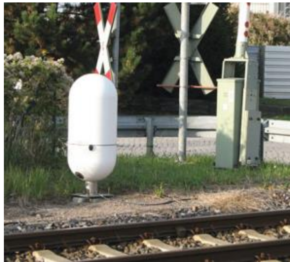
Abb. 2-3: Radarscanner an einem Bahnübergang(vgl. [1], Seite 44)
