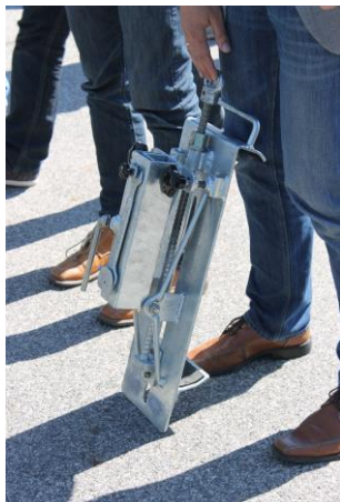
ABB 1. Universalvorrichtung zur Montage von Sensoren und Kameras an Leitschienen
