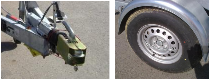
Abbildung 13: Möglichkeit einer Diebstahlsicherung bei fahrbaren Anzeigetafeln
