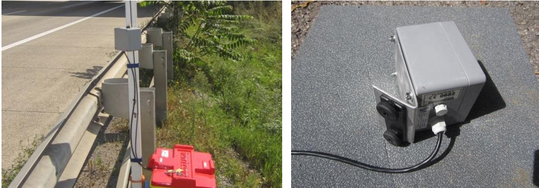
Abbildung 4: montierter Radarsensor vor Ort und fixe Montage auf einem Winkel
