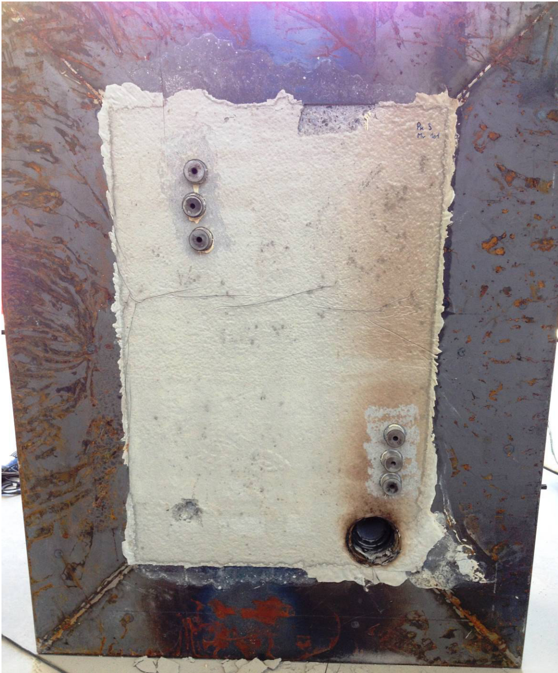
Abbildung 114: PK3 MV 101, Probekörper nach dem Brandversuch.
