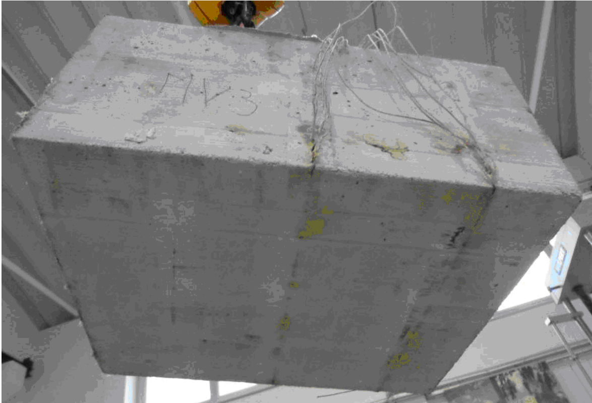
Abbildung 20: Lage der Thermoelemente im Probekörper)
