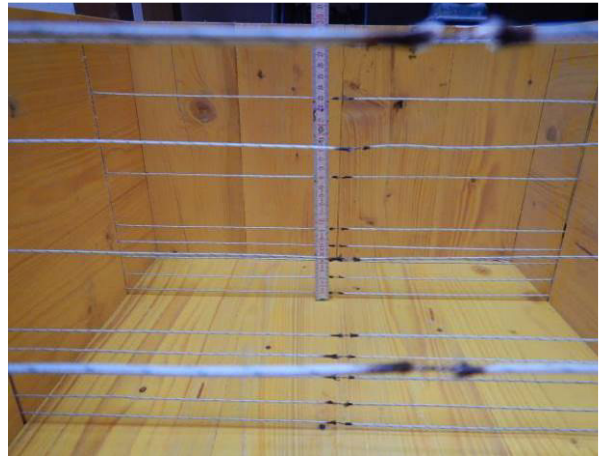
Abbildung 14: Anordnung der Sensoren über die Probekörperhöhe
