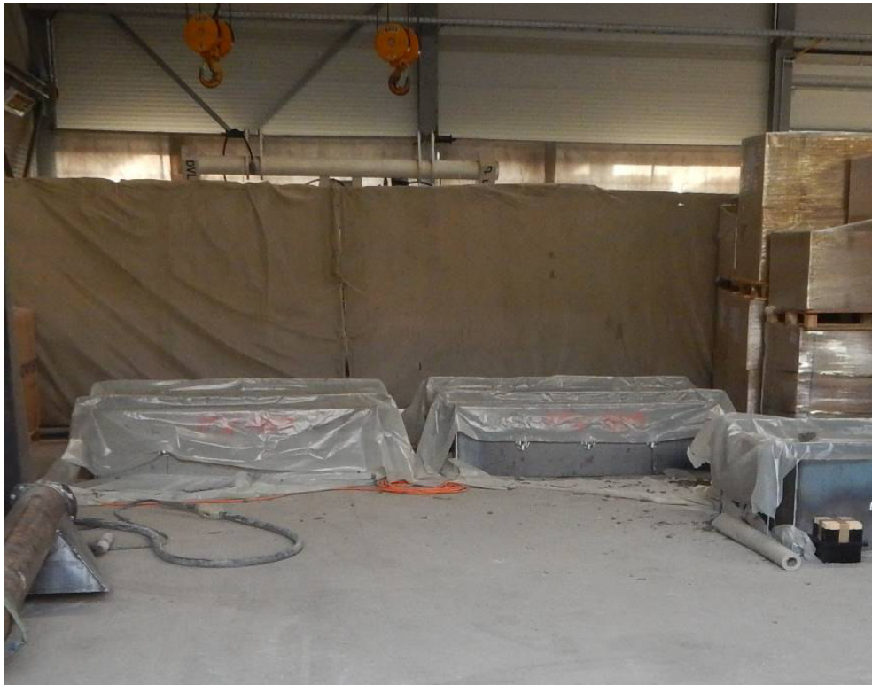
Abbildung 108: Lagerung der Probekörper für die ersten 14 Tage
