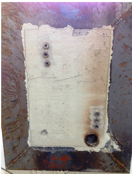
ABB 1. Großprobekörper (Untersicht) nach dem Brandversuch
