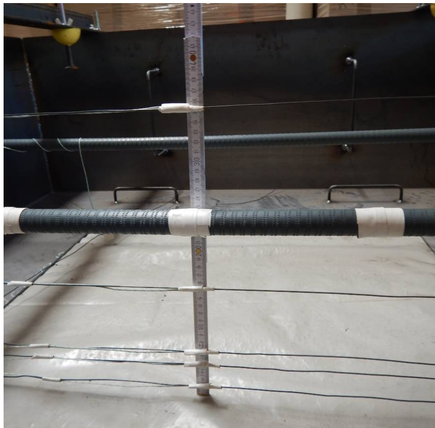
Abbildung 107: Fühler in der Höhe von 2,5, 5,5, 7,0, 25 und 35 cm mittig im Großprobekörper
