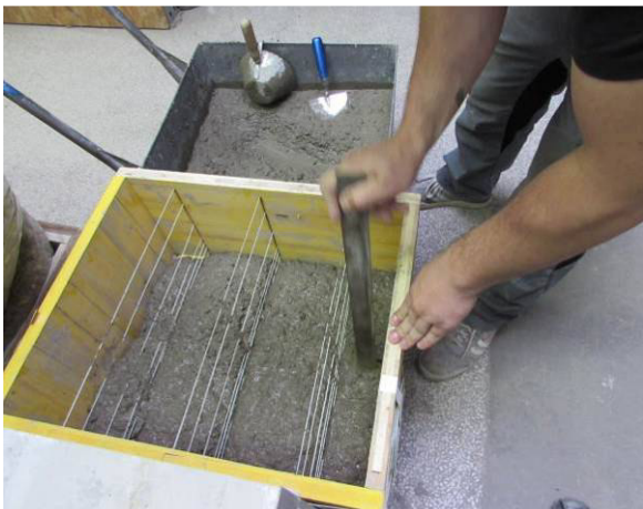
Abbildung 15: Einfüllen und Verdichten des Betons
