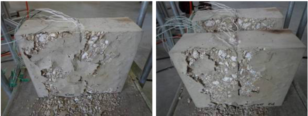
Abbildung 102: Dehydrierte und absandende Oberflächen der Probekörper
