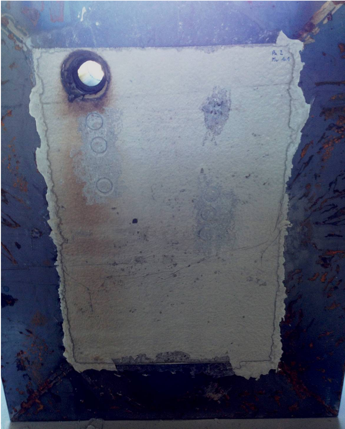
Abbildung 113: PK2 MV 101, Probekörper nach dem Brandversuch.
