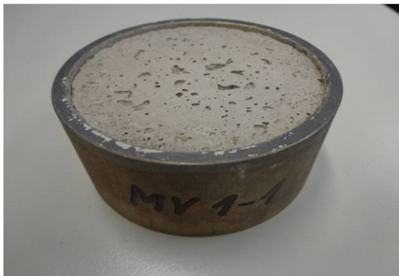
Abbildung 98: Links: Probe MV1 PK1; rechts: Bestimmung der intrinsischen Permeabilität
