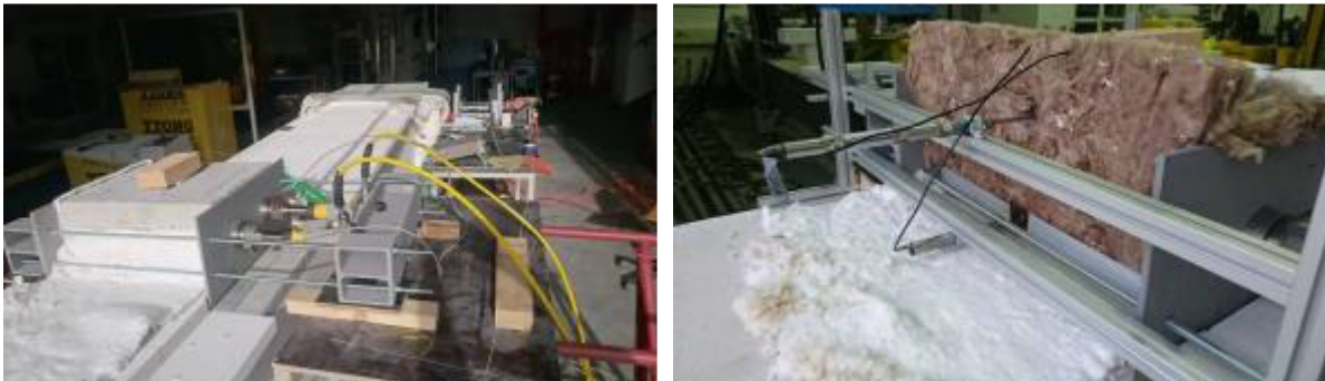
Abbildung 23: Versuchsanordnung, links: Spannrahmen, rechts: Dehnungsmessung
