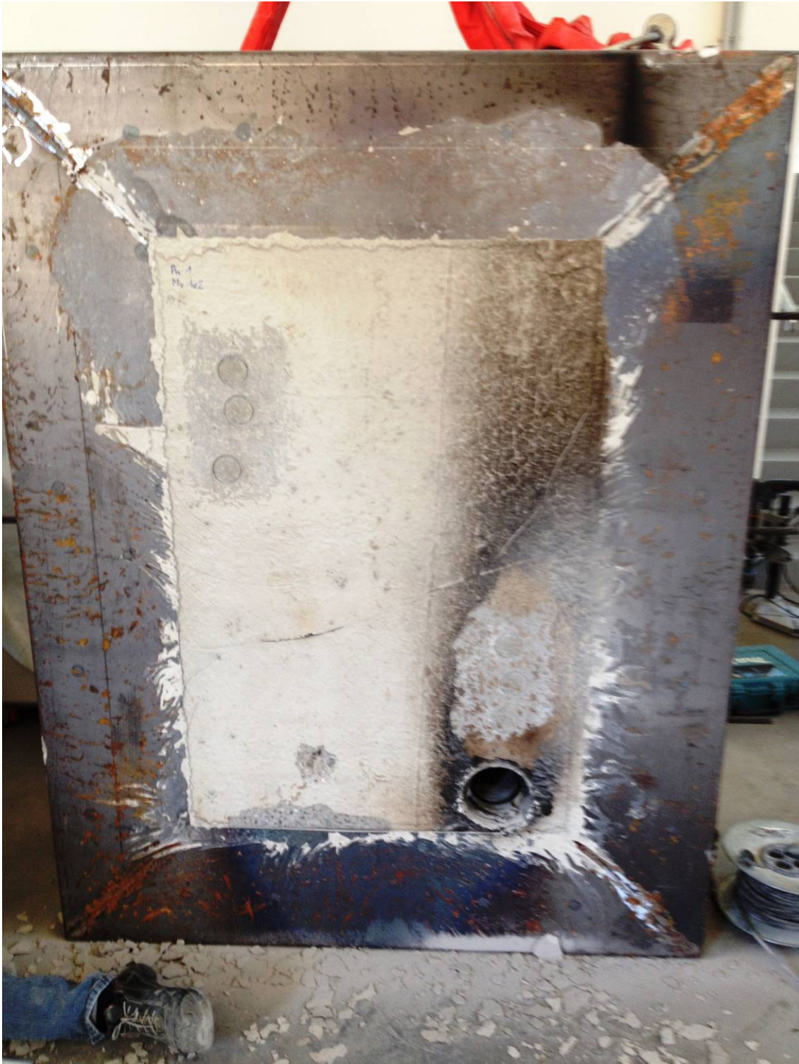
Abbildung 116: PK1 MV 102, Probekörper nach dem Brandversuch.
