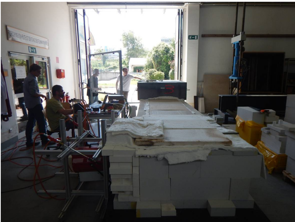
Abbildung 104: Adaptierter Brandraum für die Versuche mit den Großkörpern
