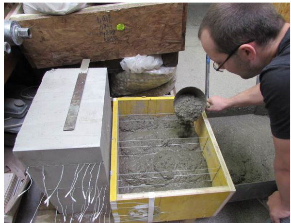
Abbildung 16: Einfüllen des Betons 2. Lage
