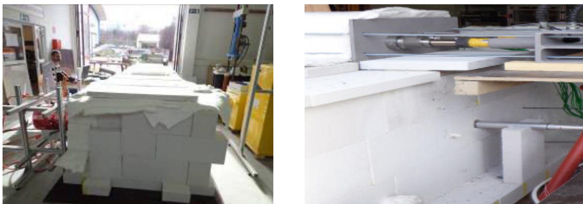
Abbildung 24: Darstellung des Brandraums, links: Brandkanal, rechts Anordnung der Temperaturfühler und des Massenströmsensors
