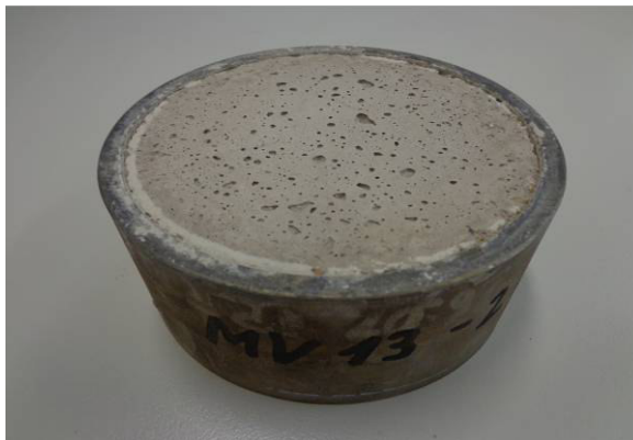
Abbildung 99: Links: Probe MV13 PK2; rechts: Bestimmung der intrinsischen Permeabilität
