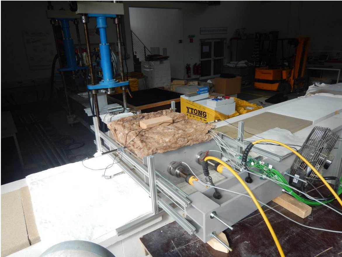
Abbildung 22: Spannrahmen zur Aufbringung einer Quervorspannung von 1,2 MPa
