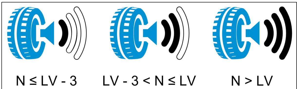
Abbildung 2.2: Darstellung der Klasse des externen Rollgeräusches
