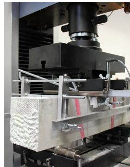
Abb. 12: Prüfanordnung für den Biegezugversuch mit Schiene und LVDT
