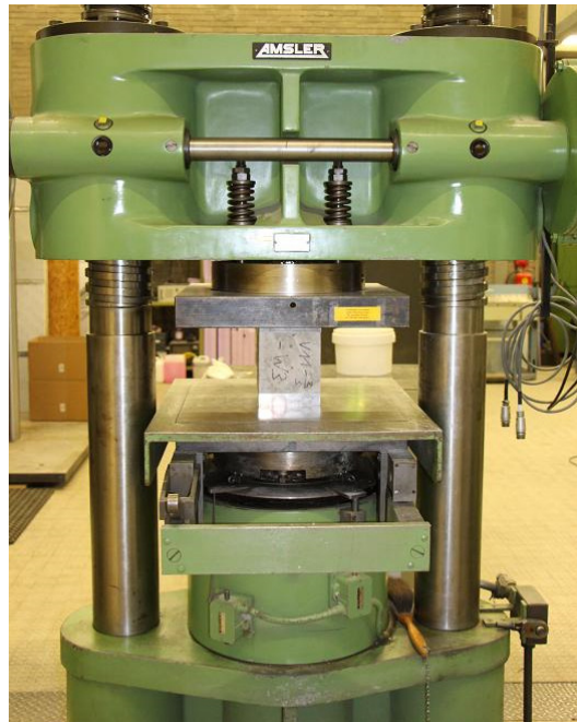
Abb. 7: Prüfanordnung zum Druckversuch
