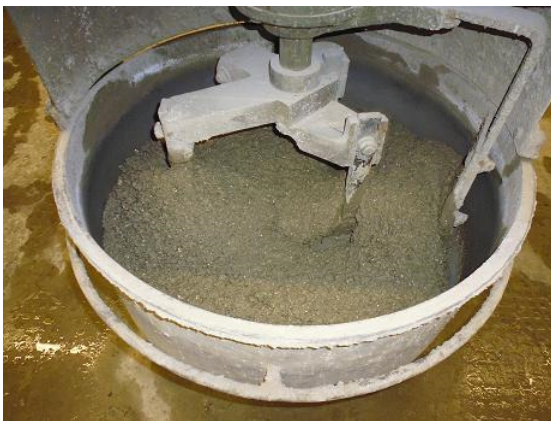
Abb. 14: Herstellung der Betonmischungen im Zwangsmischer
