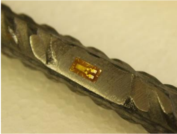
Abbildung 4.24: DMS auf der Bewehrung
