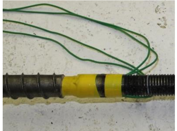
Abbildung 4.25: Mit DMS bestückte Schraube
