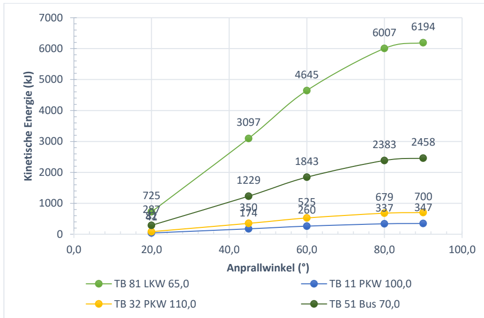
Abbildung 3-3 Kinetische Energie in Abhängigkeit vom Anprallwinkel bei Normgeschwindigkeit
