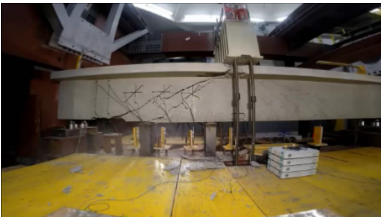
ABB 1. Typisches Rissbild bei einem Querkraftversagen eines Spannbetonträgers mit geringer Schubbewehrung
