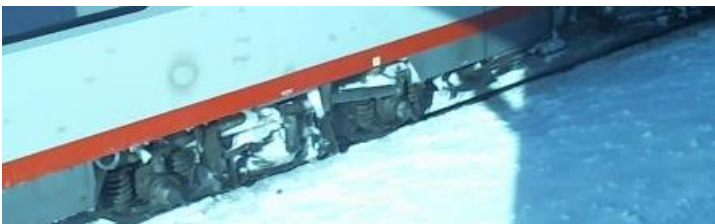
ABB 1. Schnee- und Eisanhaftungen seitlich am Zug
