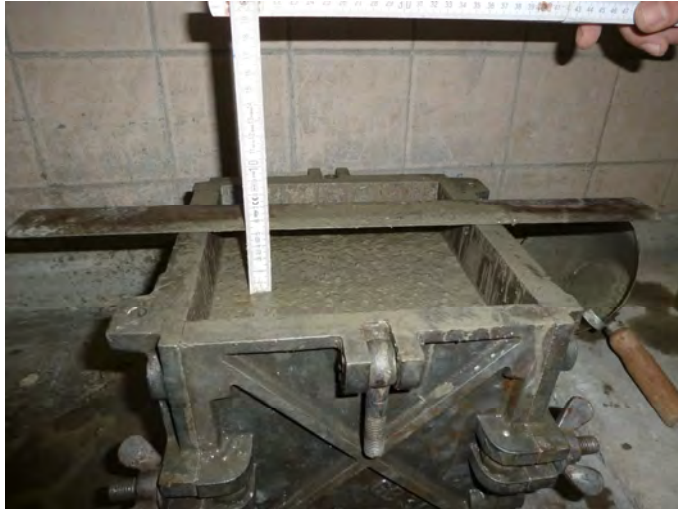
Abbildung 15: Bestimmung des Verdichtungsmaßes
