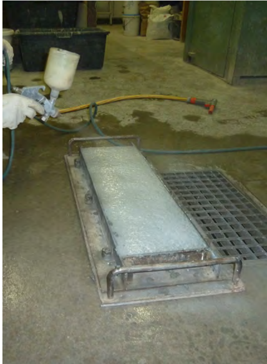
Abbildung 16: Aufbringen des Kombinationsmittels direkt nach der Herstellung
