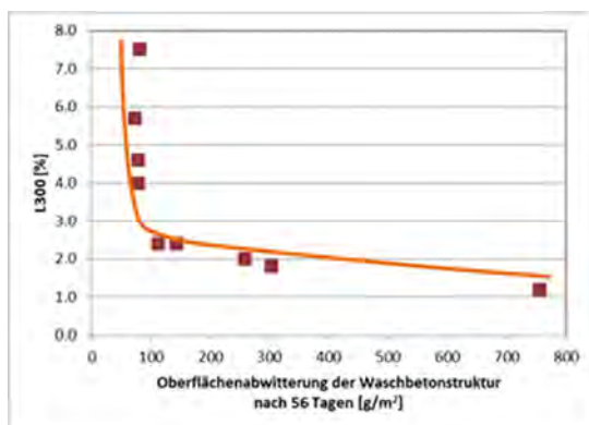
Abbildung 1: Zusammenhänge Luftporenkennwert L300 und Oberflächenabwitterung nach 56 Frost- Tauwechsel- Beanspruchungszyklen
