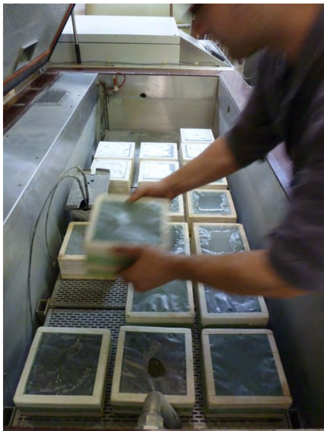
Abbildung 21: Prüfkörper während der Prüfung der gleichwertigen Beständigkeit für die Expositionsklasse XF4
