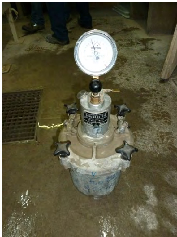
Abbildung 14: Bestimmung des Luftgehaltes am Frischbeton
