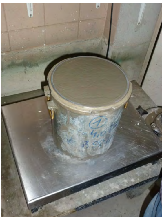
Abbildung 13: Bestimmung der Rohdichte am Frischbeton
