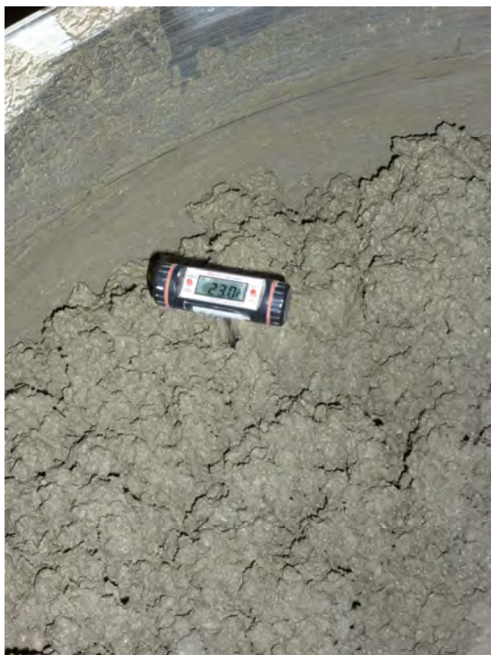
Abbildung 12: Bestimmung der Frischbetontemperatur
