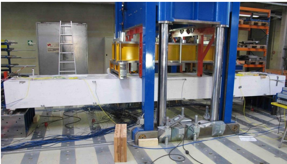
Abbildung 35: Seitenansicht des Biegeträgers im 4-Punkt-Prüfgerüst. am LKI
