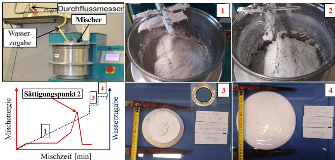
**Abbildung 12 Versuchsaufbau „MEM-ST“ und Versuchsablauf: Stoff in pulverförmigem (1), gesättigtem (2) und fließfähigem Zustand (3,4). Links unten: Diagramm des Mischenergieeintrages und der Wasserzugabe während der Mischzeit**
