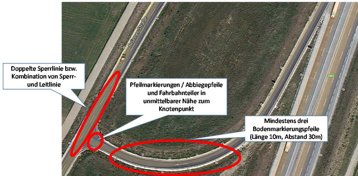
Abbildung 36: Vorschläge für RVS-gemäße Verbesserungsmaßnahmen an der HAST Gaweinstal Nord
