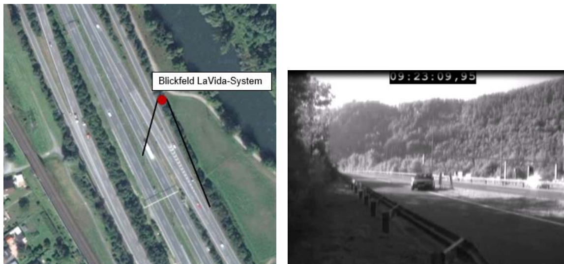
Abbildung 59: HASSt Graz Nord; Standort der Videobeobachtung und Beispiel für Fehlverhalten (Befahren der Sperrfläche am Absprungpunkt der Rampe)
