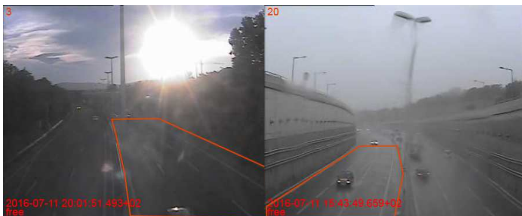
Abbildung 2: Gegenlicht (links) und starker Niederschlag (rechts)
