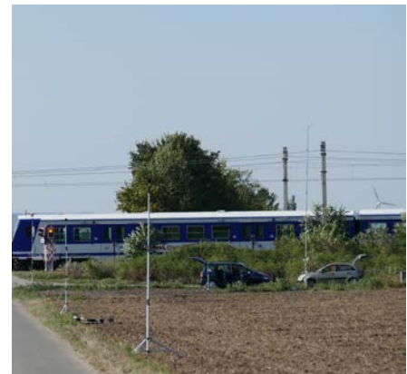
ABB 1. Messaufbau an einer Schienenstrecke mit Schallpegelmessung an mehreren Mikrofonpositionen und Messturm für Meteorologie
